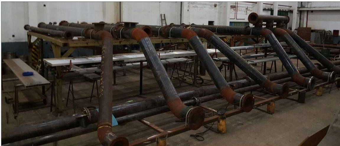
Una vez finalizado el armado y soldado las bridas y codos en su posición definitiva se llevaron los caños a arenar y pintar para su posterior armado en el taller de mecánica.
