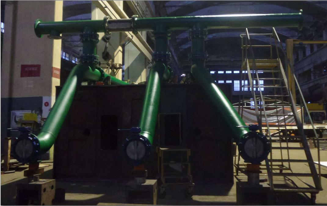
Como se puede ver en la foto las válvulas globo del colector no fueron montadas ya que todavía no se encuentran en el Astillero, por lo cual se construyó un muñeco que representa dicho válvula respetando las medidas de la misma.
