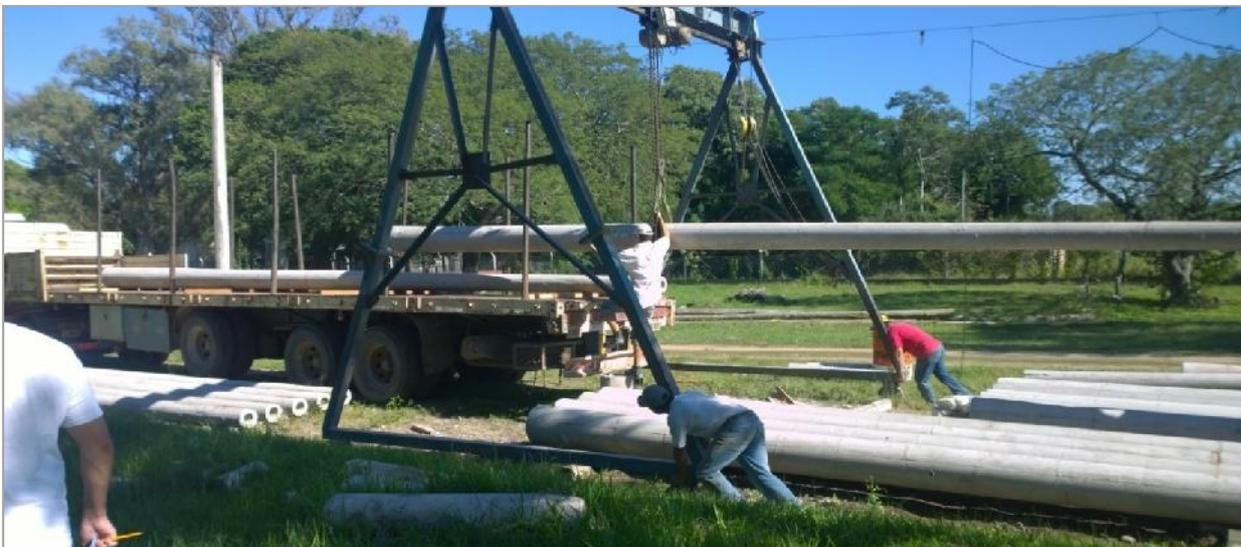
El movimiento de los mismos se realiza a través de un puente grúa que cuenta con un aparato con accionamiento eléctrico, y es desplazado manualmente por los operarios. En este sector se carga también los camiones con el material para despacho. Dimensiones del sector: 6,50 x 53 metros
