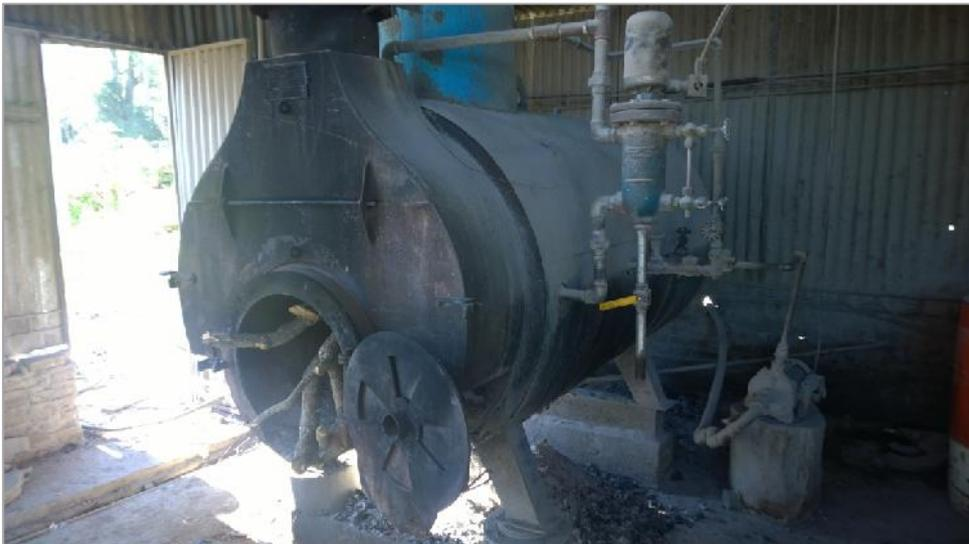
Esta caldera es utilizada para impulsar vapor de agua al interior de los moldes (tubo concéntrico), lo que permite acelerar el proceso de fraguado del hormigón.
