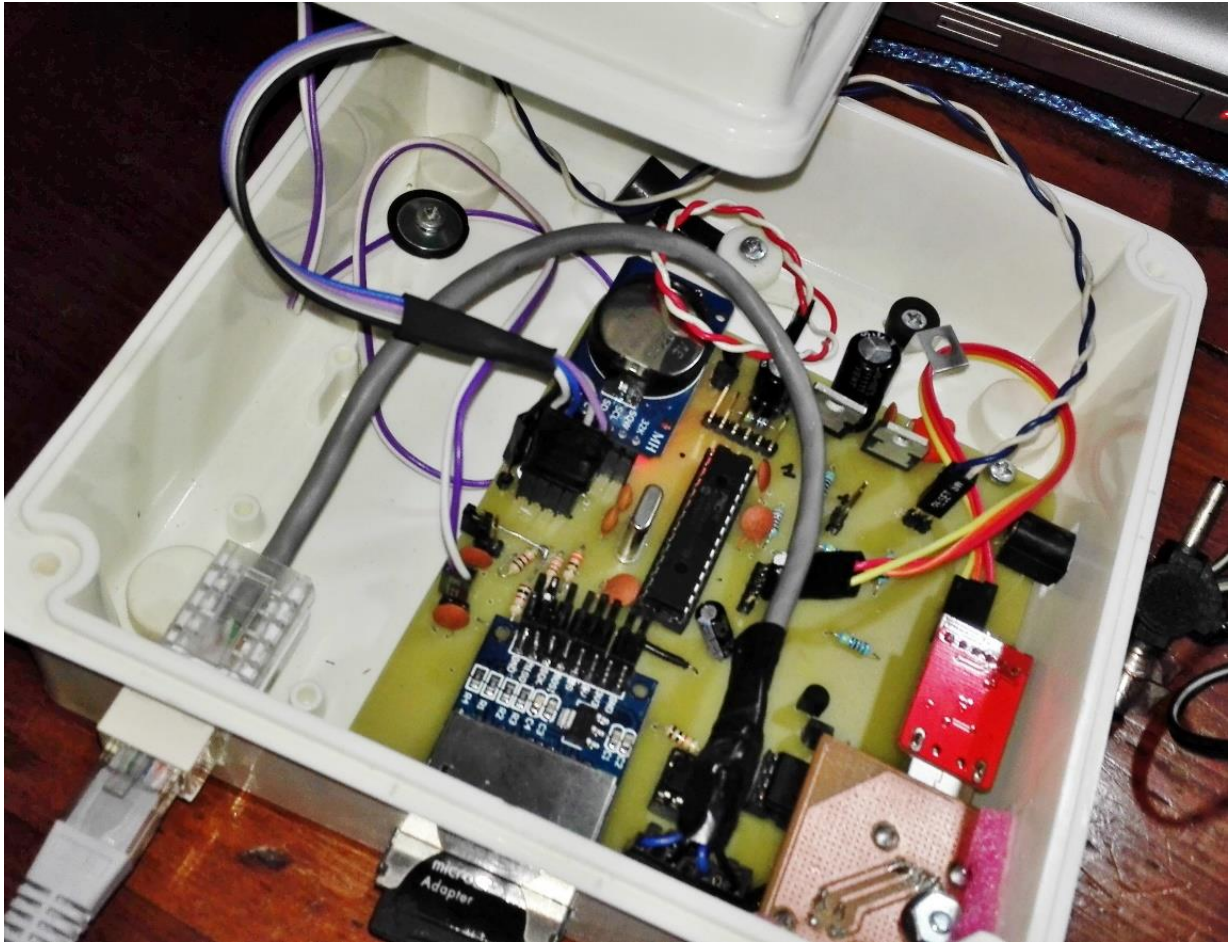
Figura 20. Placa registradora en gabinete. Interior
