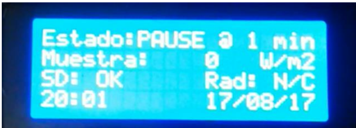
Figura 55. Interfaz de estado LCD. Información en pantalla
