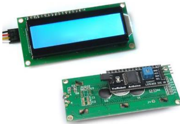
Figura 52: Interfaz de estado LCD. Módulo comercial descartado
