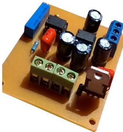
Figura 4. Placa adaptadora de señal de radiómetro al rango [0 ; 10][V]
