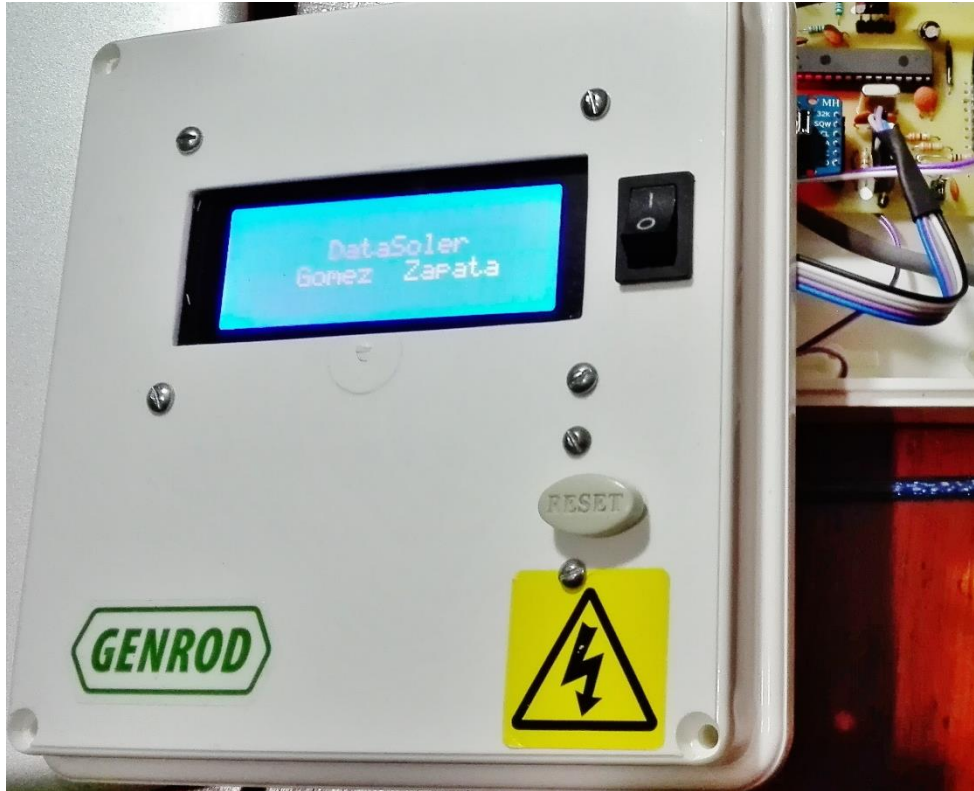
Figura 54. Interfaz de estado LCD: Instalación en gabinete
