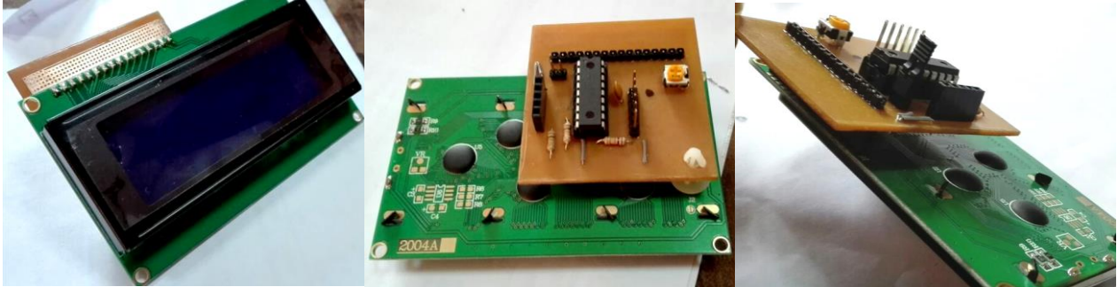
Figura 53. Interfaz de estado LCD. Módulo de diseño propio
