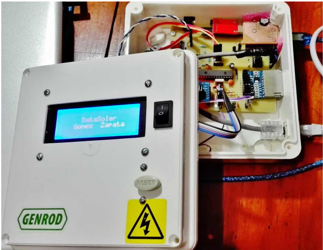
Figura 19. Placa registradora en gabinete. Display en pantalla inicial
