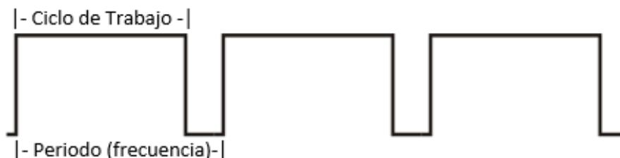
Figura 42: Ejemplo de salida HSO
