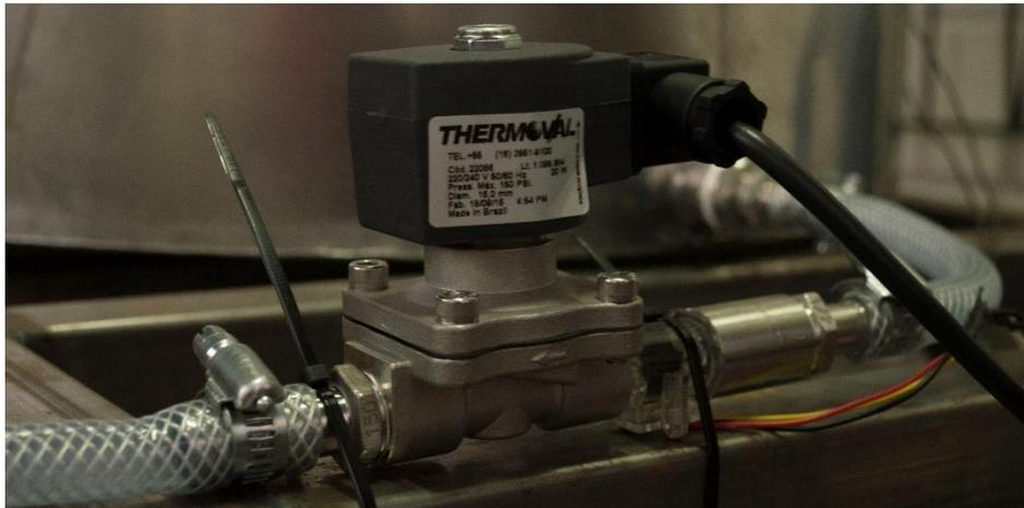
*Figura 60: Electroválvula N° 2 y caudalímetro N° 2.*
