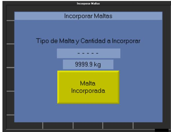
Figura 89: Pantalla de aviso para la incorporación de malta
