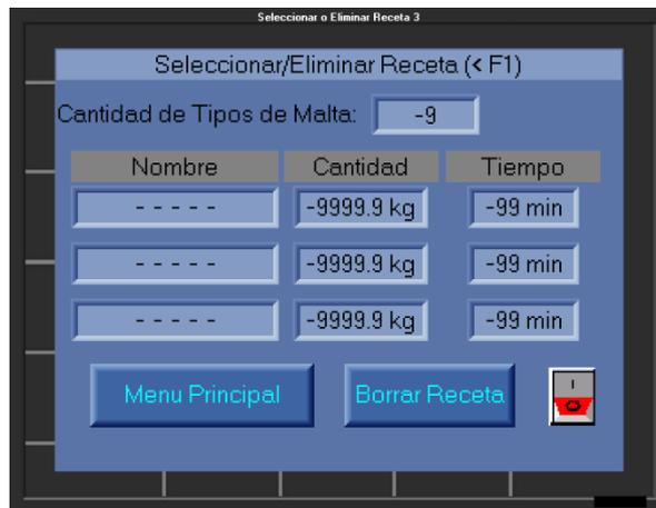
Figura 76: Pantalla para seleccionar o eliminar una receta (3 de 3)
