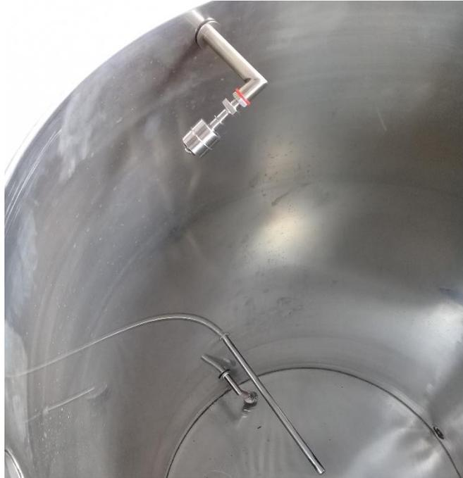
*Figura 58: Boyas de nivel dentro en la olla de cocción*
