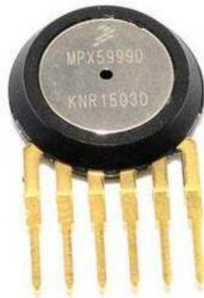
*Figura 25: Sensor de presión MPX5999D*
