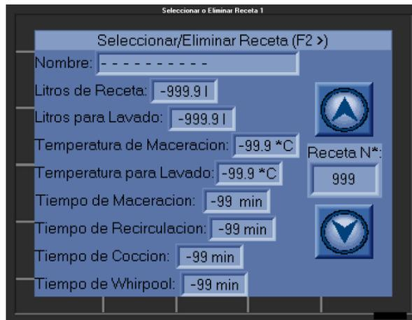
Figura 74: Pantalla para seleccionar o eliminar una receta (1 de 3)
