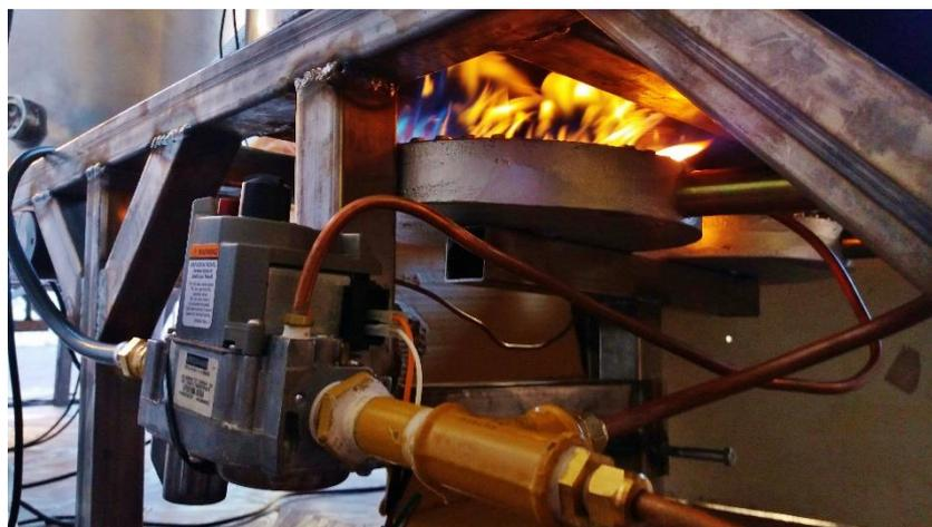
*Figura 57: Instalación de gas y quemadores en etapa de prueba*
