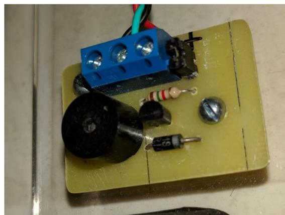
Fig. 40: Fotografía de la Placa generadora de señal sonora.
