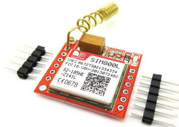
Fig. 36: Módulo SIM800L<sup>31</sup>.
