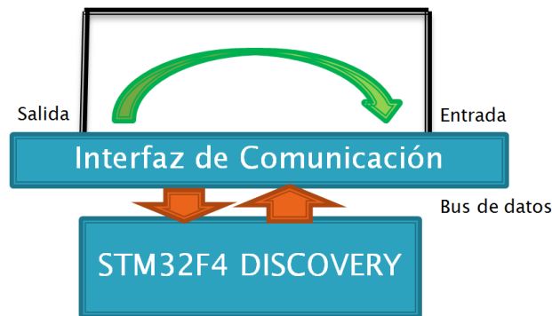
Figura 34: Esquema de la prueba de loopback para verificar el comportamiento del firmware y bus de datos.
