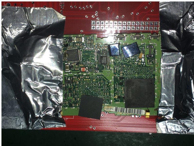
Figura 20: Placa de sacrificio (en verde) con los integrados BGA desoldados. La placa roja, al fondo, se utilizó para disipar el calor del PCB pequeño y generar problemas.
