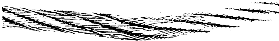
Fig. 16.— Cable que se puso en servicio a pesar de una coca y estando sujeto a un desgaste localizado. Deformación típica. El cable debe ser retirado.
