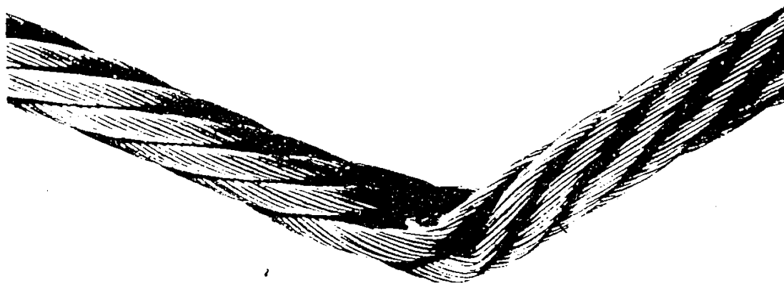
Fig. 20.— Ejemplo de codo muy marcado. El cable debe ser retirado.
