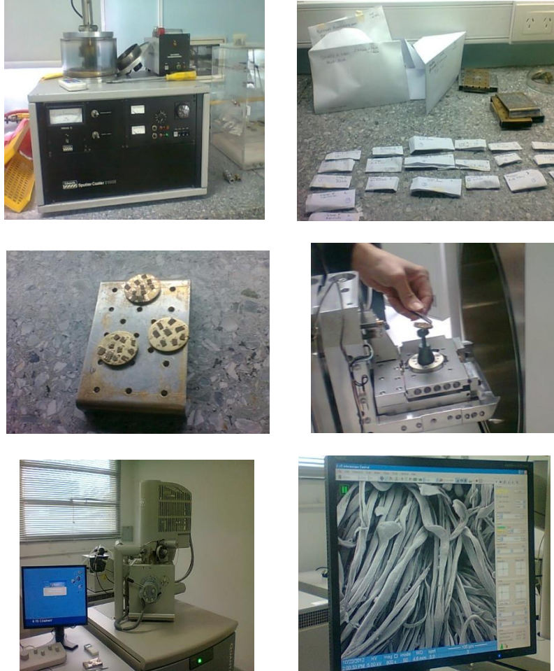
Figura 42 - Metalizadora Edwards, recubrimiento de oro y equipo SEM
