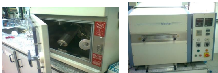
Figura 24 – Equipo Labomat Mathis (Izquierda), Rama Mathis (derecha)
