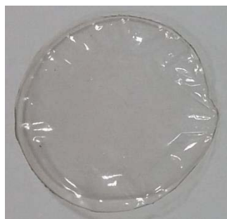
Figura 1. Película de quitosano al 1% p/p con GA al 1% p/p y SB al 2,5% p/p.
