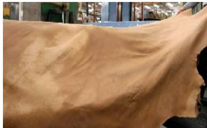
El **CUERO TERMINADO**, se obtiene una vez obtenido el semi-terminado y aplicando protección con pinturas y lacas y combinando este proceso con trabajos mecánicos. En la empresa, la terminación será realizada por el cliente, según los usos futuros que quiera darle.
