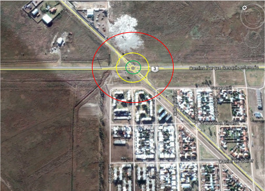
Imagen 13. Rotonda 2: Curvas de Consecuencias para Sobrepresión (Etileno). Fuente: Elaboración propia a partir de Google Earth.
