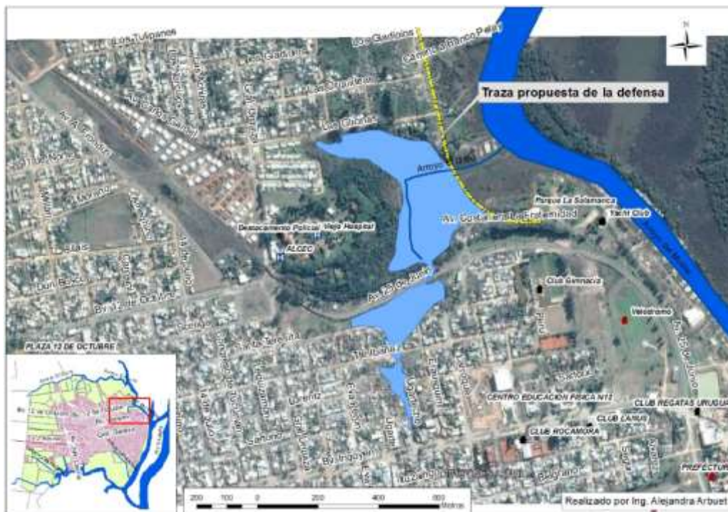
Figura N° 240. Crecida en zona de interés. Fuente: D.H.E.R.
