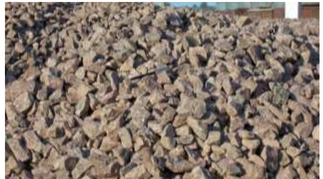
Figura Nº 205. Característica del balasto adoptado. Fuente: Elaboración propia.
