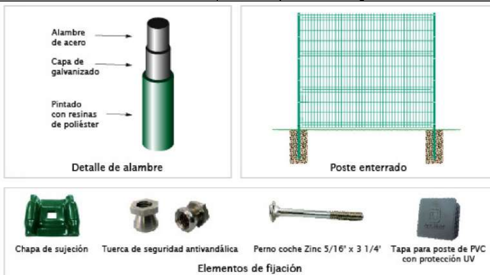
Figura Nº 211. Detalles generales de alambrado urbano. Fuente: ADIFSE.
