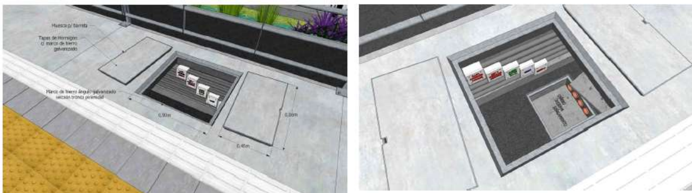
Figura Nº 281. Acceso al bajo badén. Fuente: ADIFSE
