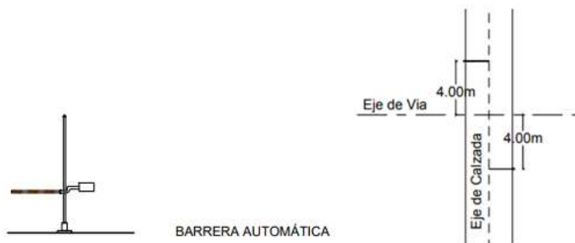
Figura Nº 253. Imágenes de barrera automática. Fuente: SETOP
