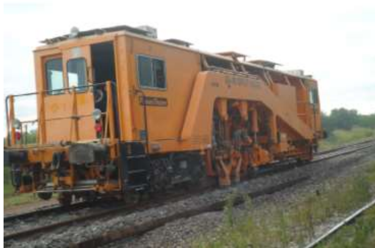
Figura N° 267. Imagen de trabajos de estabilizado de vía. Fuente: Blog Crónica Ferroviaria
