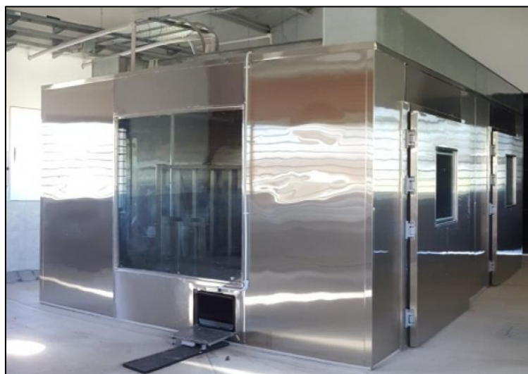
Figura 12: Cámara de ambiente controlado (Fuente: ria.inta.gob.ar , 2016)
