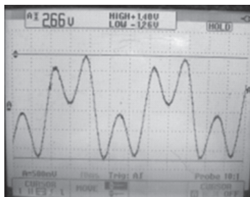
FIGURA 8. Curvas de fems en la placa impresa. Las líneas superior e inferior indican los valores máximos de la fem inducida en la placa impresa por los imanes rotantes
