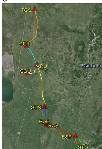
Figura 1. Corredor radial de 132 kV Santo Tomé-Tostado
