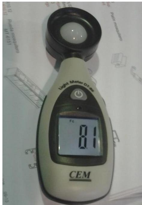
Imagen N°62: Luxómetro Digital, Marca CEM.
