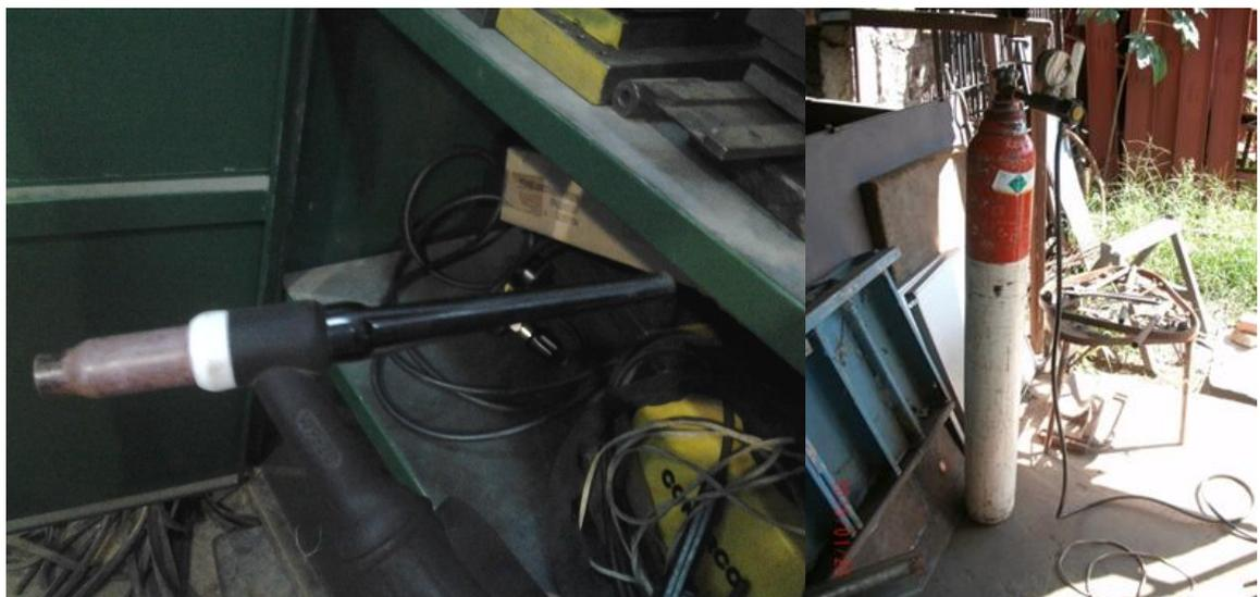
Imagen N°45: Antorcha con electrodo de tungsteno – Tubo de Argón
