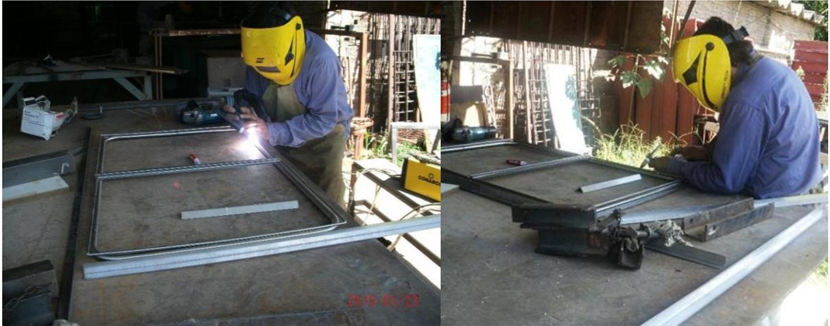
Imagen N°46: Uso de Máquina de soldar TIG
