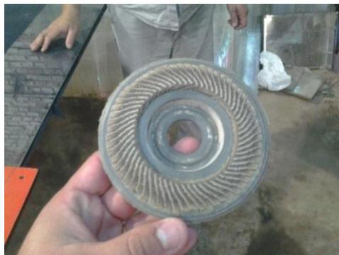
Imagen N°50: Disco abrasivo tipo Flap
