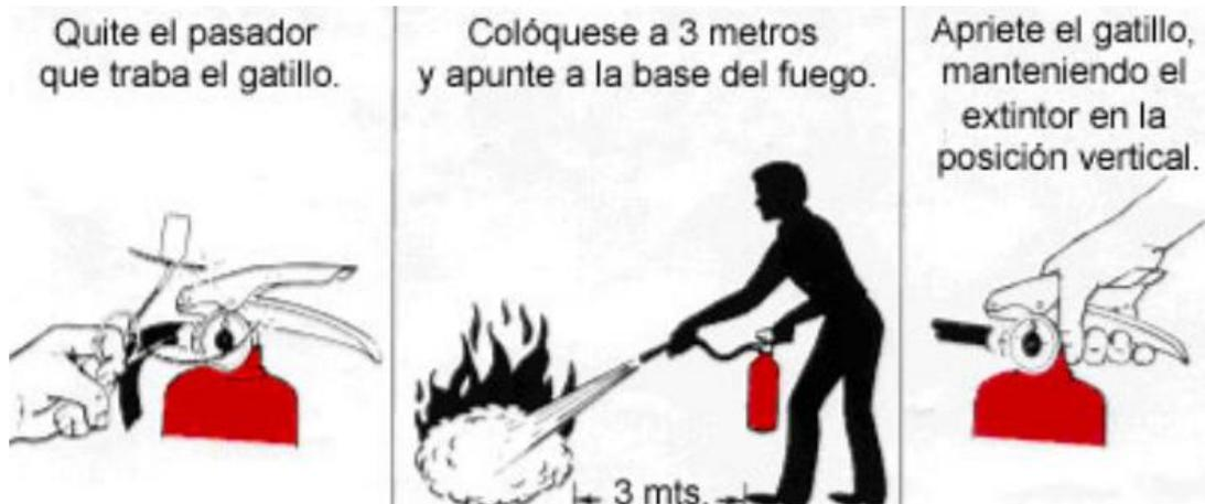
Imagen N°53: Procedimiento de utilización correcta del Matafuego
