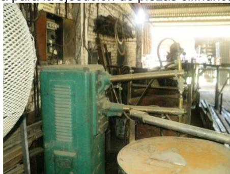
Imagen N°31: Máquina de soldar de Punto
