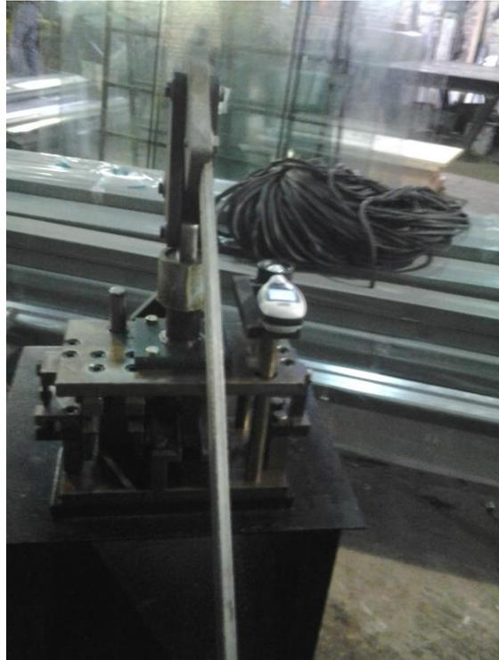
Imagen N°66: Luxómetro ubicado sobre plano de punzonadora
