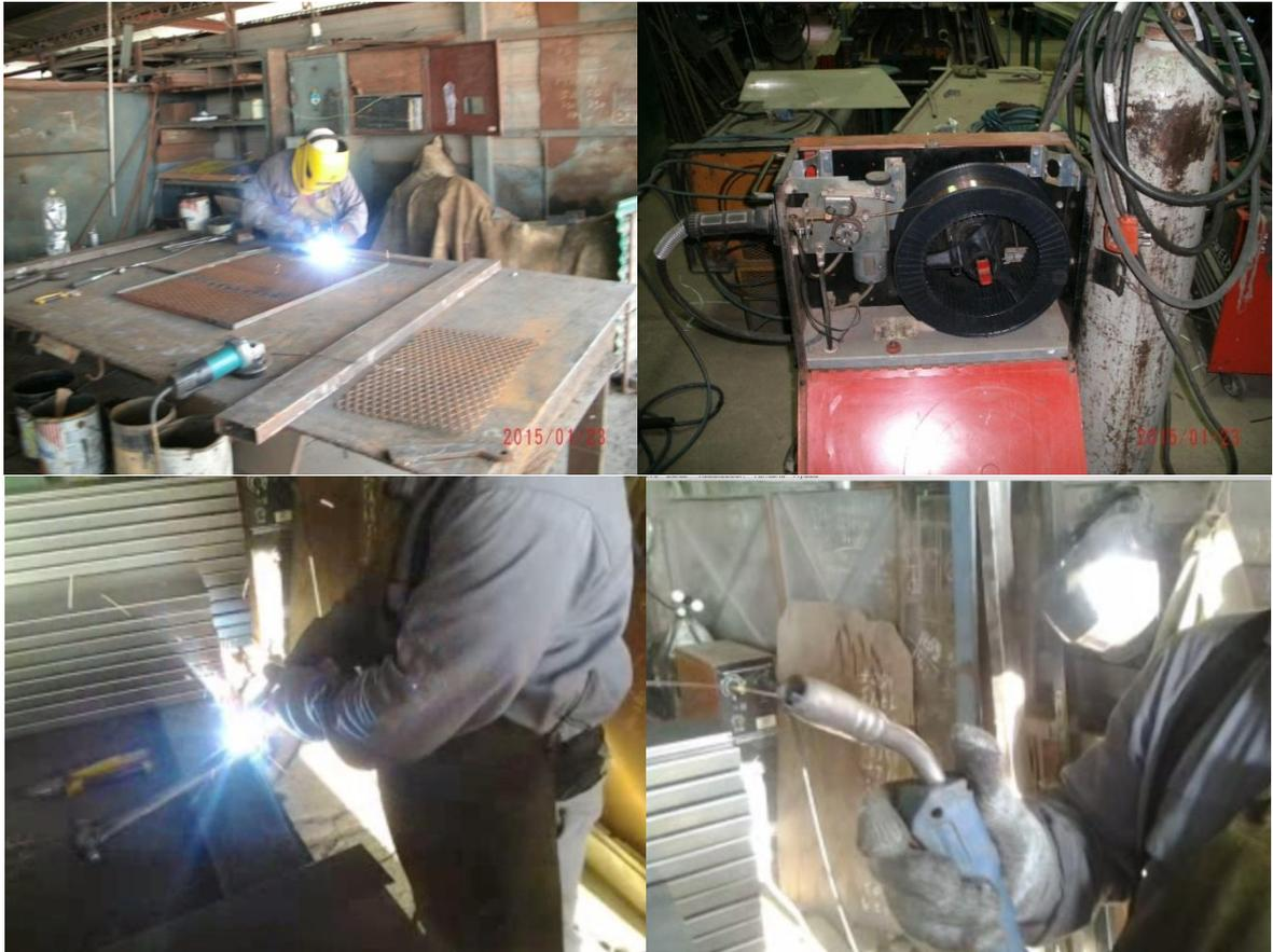
Imagen N°30: Máquina de soldar MIG MAG
