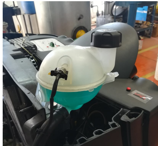
Fig. 5.7: Depósito de llenado refrigerante.
