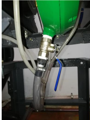
Fig 5.33: Válvula de regulación fija en la salida de agua del dinamómetro.
