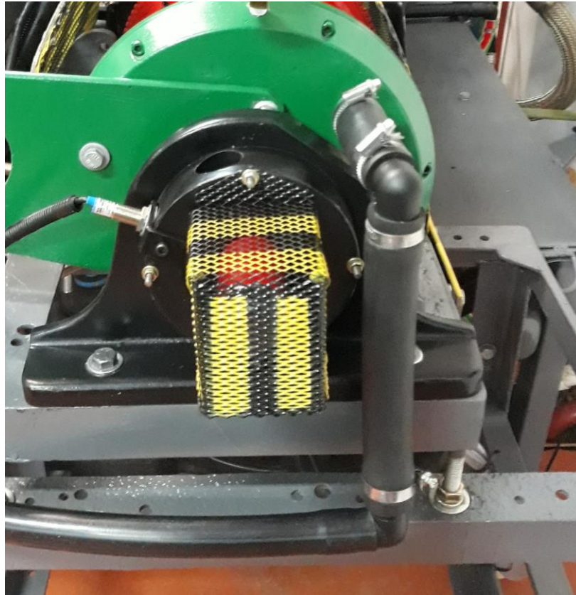
Fig. 5.15: Entrada de agua al dinamómetro.
