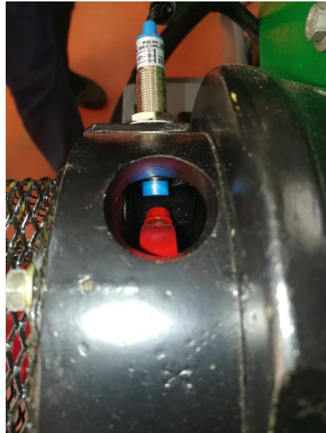
Fig. 5.26: Sensor inductivo montado en dinamómetro.
