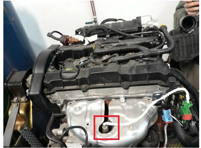
Fig. 3.15: Ubicación del sensor de oxígeno AFR1.
