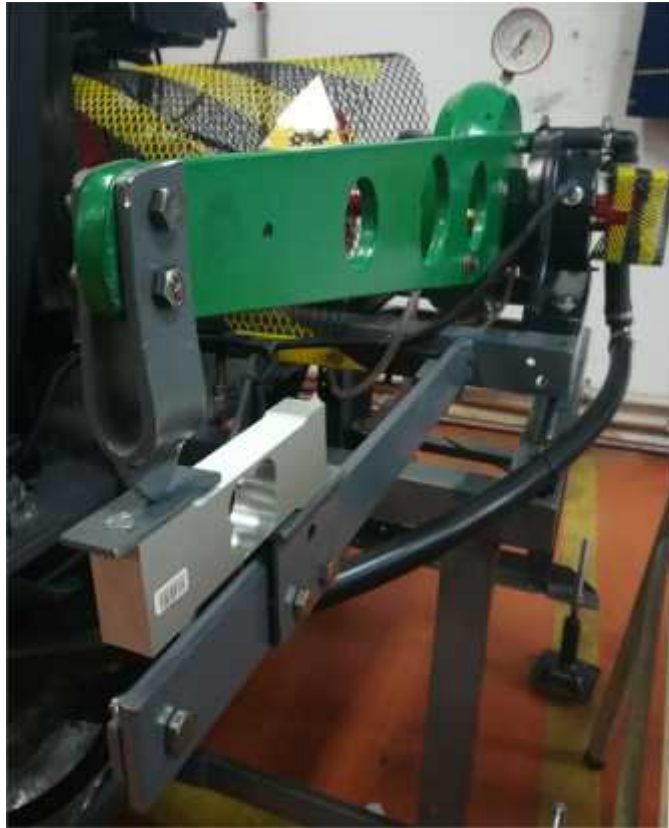
Fig. 1.6: Dinamómetro hidráulico instalado.
