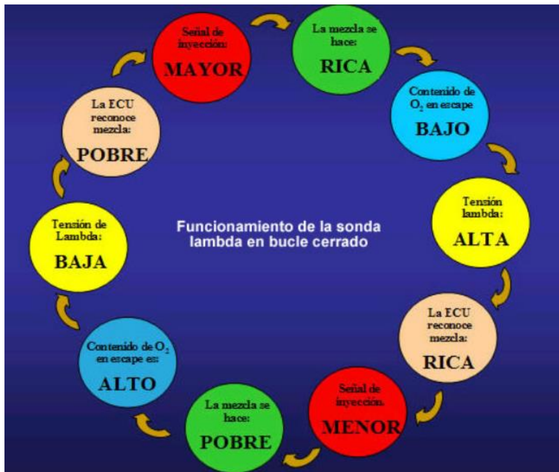
Fig 5.37: Funcionamiento sonda lambda. Fuente: http://www.aficionadosalamecanica.net
