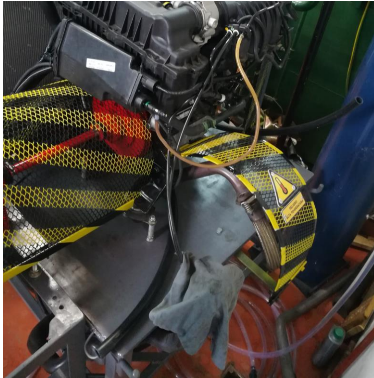
Fig. 5.19: Barrera de protección del sistema de transmisión y escape del motor
