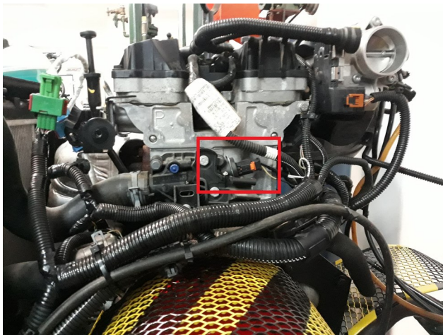
Fig. 3.9: Ubicación del sensor ECT en el motor EC5.
