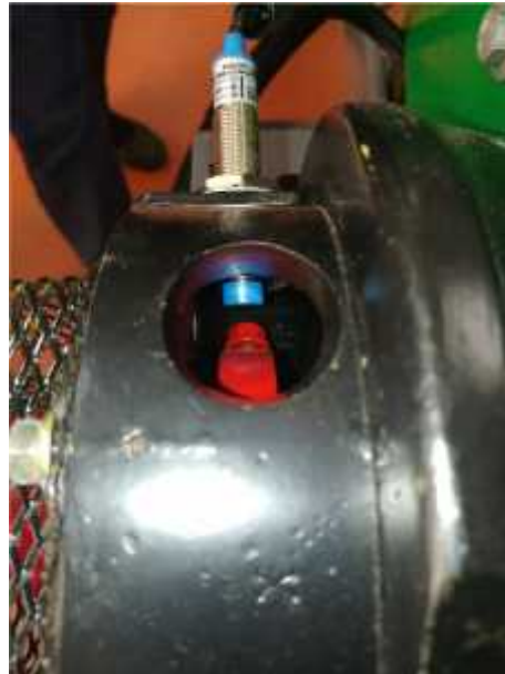
Fig. 2.5: Sensor inductivo enfrentado al tornillo de medición.
