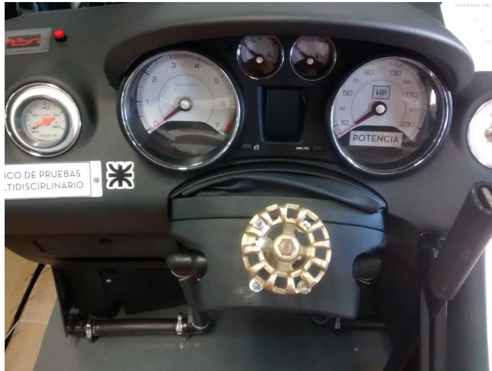
Fig. 5.14: Sistema de regulación de agua de entrada al dinamómetro.
