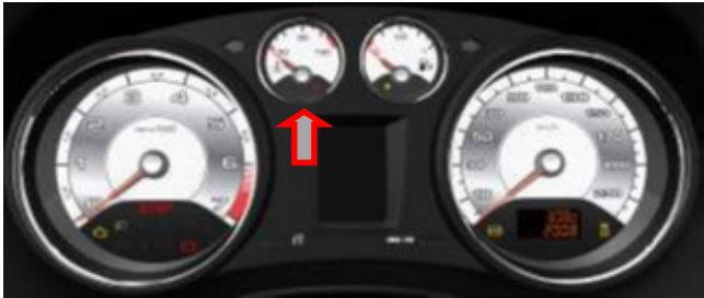
Fig. 3.8: Medidor de temperatura. Tablero de instrumentos.
