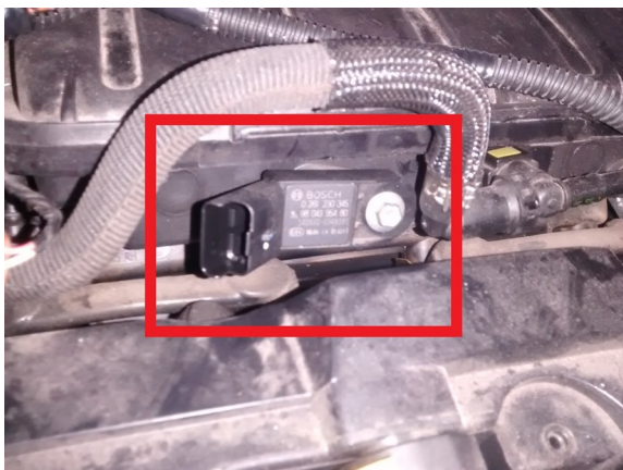
Fig. 3.18: Ubicación del sensor MAP-IAT en el motor EC5.
