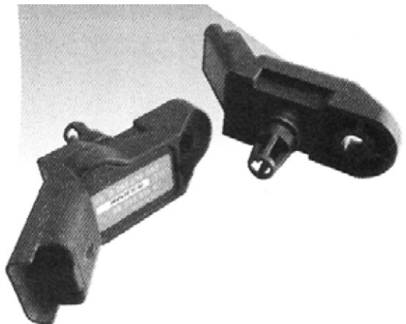
Fig. 3.17: Sensor de presión y temperatura del colector de admisión MAP-IAT.
