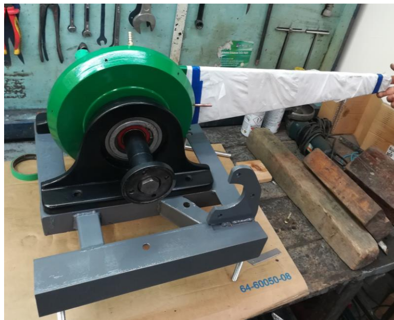
Fig. 5.8: Dinamómetro hidráulico luego de la restauración.
