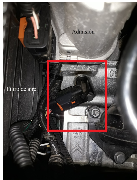
Fig. 3.5: Ubicación del sensor CMP en el motor EC5.
