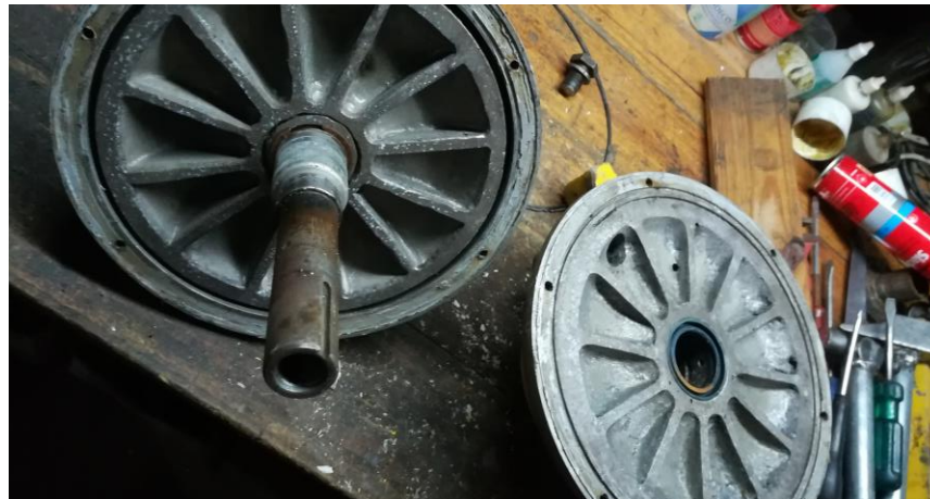
Fig. 5.7: Turbina y bomba preparados para ser rectificados.
