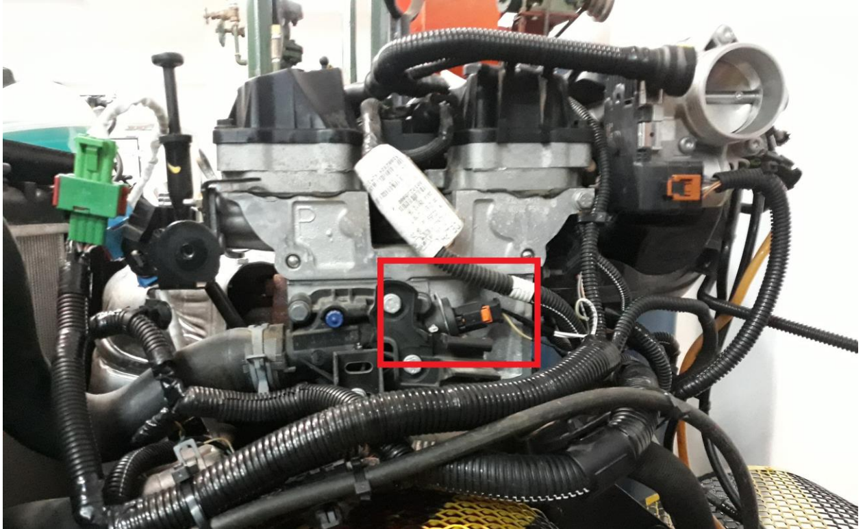
Fig. 5.36: Ubicación del sensor ECT en motor Peugeot EC5.
