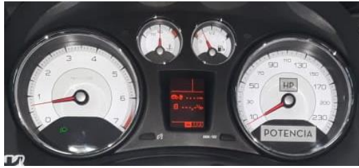
Fig. 5.27: Tablero de instrumentos con medidor de potencia en HP.
