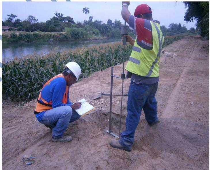
Imagen N° 16: Ensayo DCP
