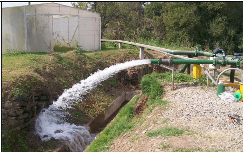
**Figuras N° 48** Ensayo de Bombeo Pozo N°7
