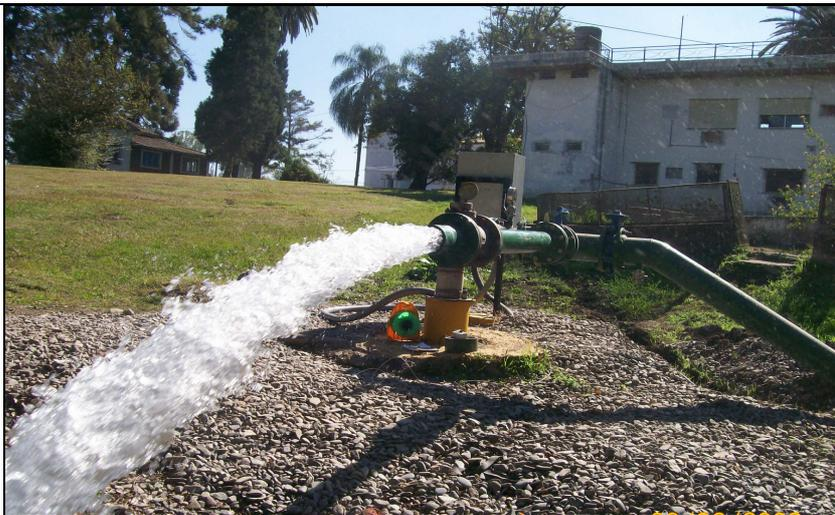
**Figuras N° 51** Ensayo de Bombeo Pozo N° 5
