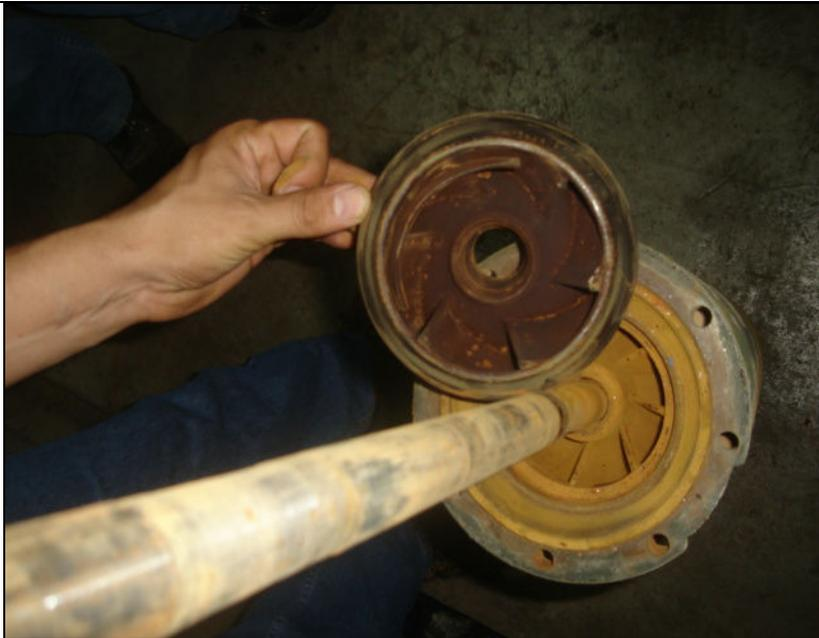
**Figura N° 63** Impulsores con desgaste por cavitación en bomba sumergible. Pozo N° 4
