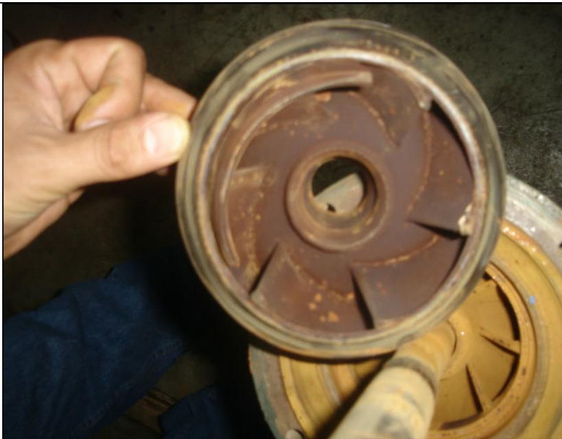
**Figura N° 64** Impulsores con desgaste por cavitación en bomba sumergible. Pozo N° 4
