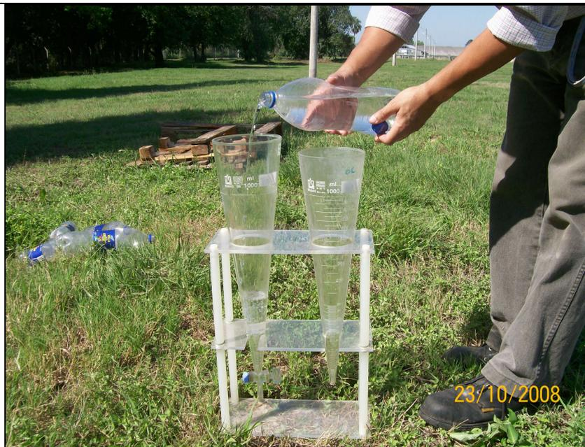
**Figura N° 66:** Sol. Sed. 10 min obtenidos de las muestras del Pozo N° 4 dentro del primer minuto de operación del pozo N° 4.
