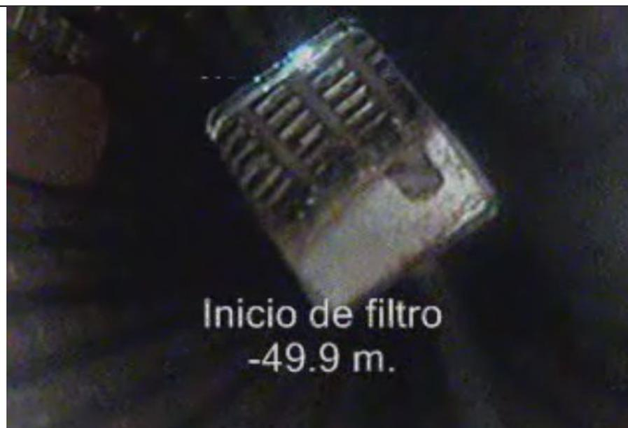
Con la información obtenida de las 7 filmaciones se procedió a confeccionar los planos constructivos de las perforaciones, considerándose datos de ubicación de filtros, datos de bombas sumergibles, reducción de la cámara de bombeo, etc. Ver **Apéndice I**.
