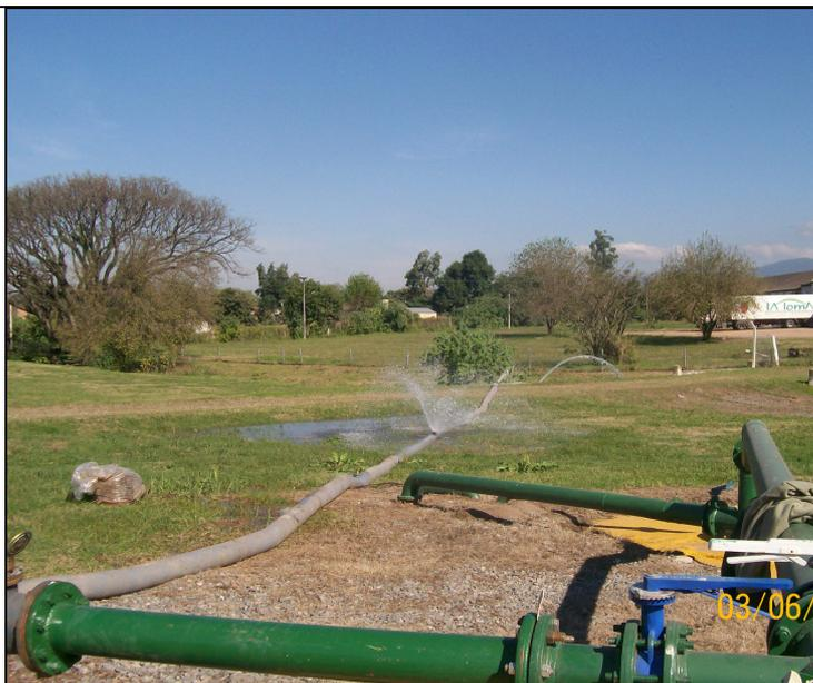
Nótese que en los pozos 2 y 7 fue utilizada una manga flexible de goma entelada para evitar la erosión que causaría la descarga libre de agua sobre el suelo vegetal y su anegamiento luego de varias horas de bombeo continuo.
