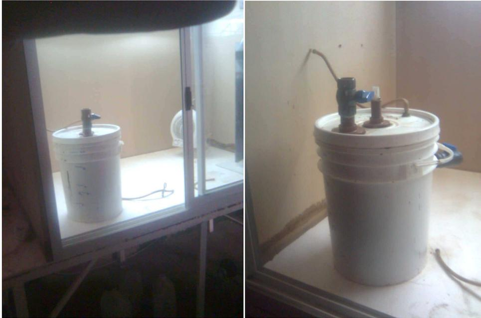
Figura 4.5. Distintas vistas del reactor de mezcla completa, utilizado como sistema de acondicionamiento de lodos en el laboratorio. En la foto de la izquierda, puede apreciarse la cámara de incubación para mantener la temperatura a 30° C.
