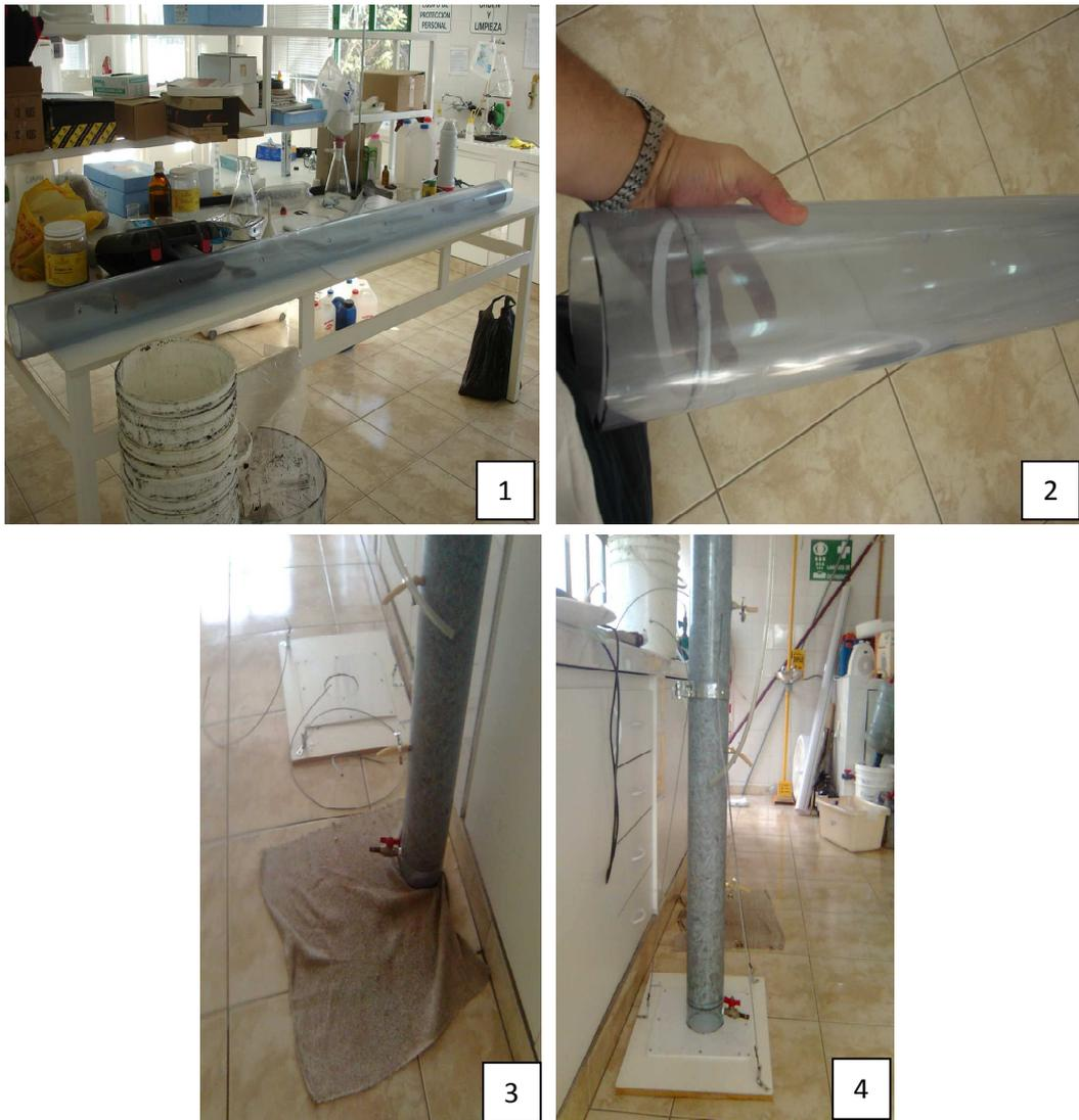
Figura 3.6 Fotos de la secuencia de armado del RALE. 1: caño de PVC cristal, utilizado como cuerpo del reactor. 2: detalle de uno de los extremos del caño de PVC. 3: el reactor relleno con fleje molido y 4: el reactor montado sobre la plataforma.
