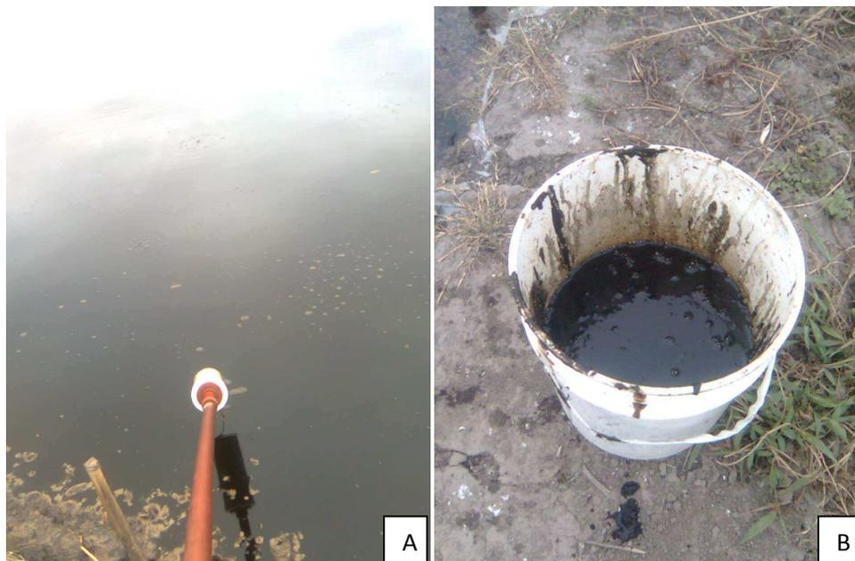
Figura 4.4. Muestreo de lodos de la Laguna 1: A) Foto tomada durante el muestreo de lodos. B) Aspecto de los sedimentos recogidos del fondo de la "laguna 1".
