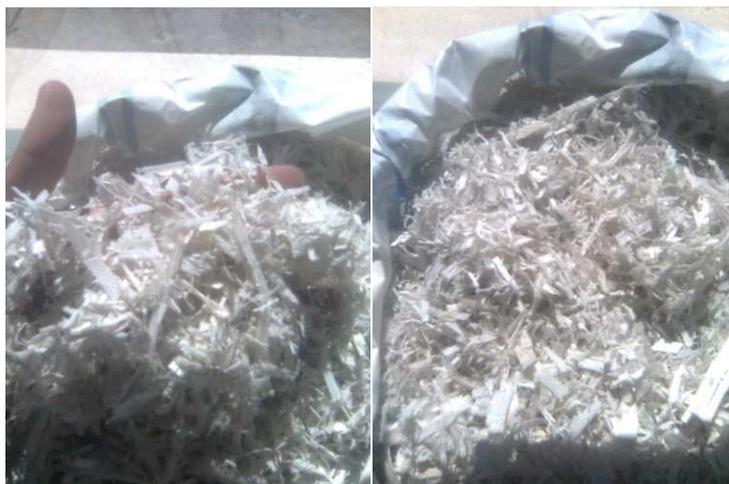
Figura 3.2. Flejes molidos, utilizados como material de relleno del RALE
