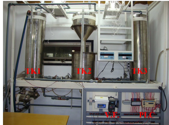
Figura 1. Fotografía de la parte superior de la planta real, ubicada en el LSC (FRSF-UTN). Se observan los 3 tanques interconectados, y la parte frontal del sistema electrónico de control. (La altura total de cada tanque es de 100 cm.)
