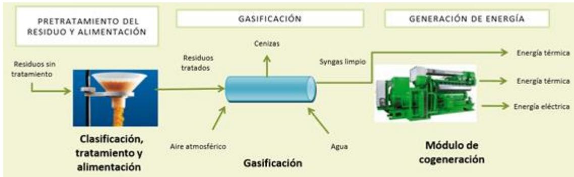
Figura 7: Ejemplo de planta de Gasificación
