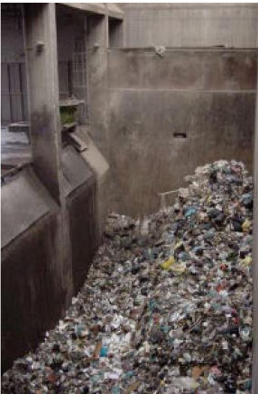
Figura 42 : ejemplo de fosa de recepción cargada de RSU
