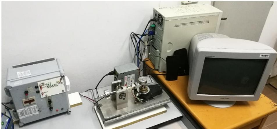
**Figura 16** – Equipo de pin on disk completo
