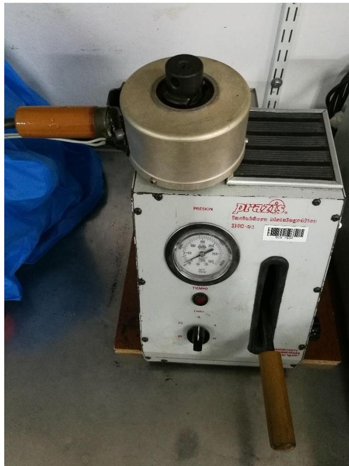
Figura 14 - Incluidora metalográfica Prazis
