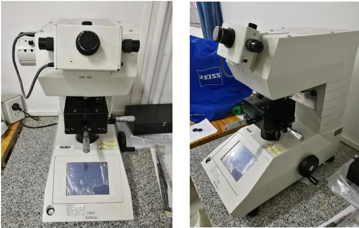
**Figura 13 - Microdurómetro Vickers Shimadzu**
