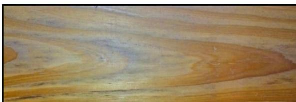
**Figura 2.29. Pieza aserrada de *Pinus elliottii* afectada por hongos cromógenos**
