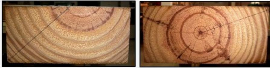
Figura 3.13. Medición de los anillos de crecimiento
