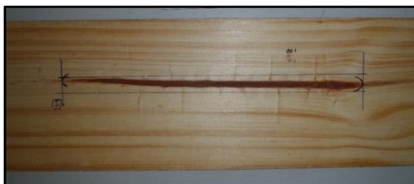
Figura 3.12. Registro de la presencia de médula en la cara lateral de una pieza aserrada
