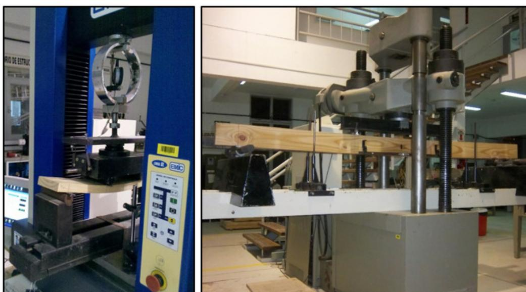
Figura 3.23. Ensayo de flexión estática. Izq.: Flexión de plano. Der.: Flexión de canto
