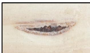
Figura 2.14. Depósito de resina presente en una pieza de *Pinus elliottii*
