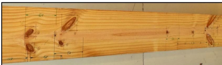
**Figura 2.11. Disposición de nudos a intervalos en una pieza aserrada de pino resinoso**
