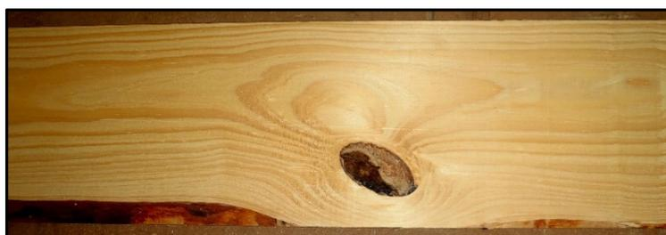
Figura 2.16. Arista faltante en una pieza aserrada de *Pinus taeda*
