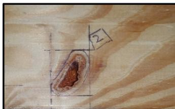
Figura 3.15. Registro de un depósito de resina
