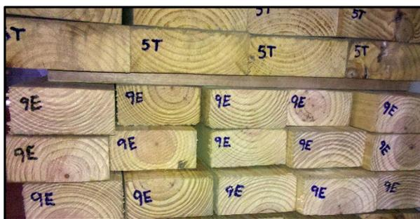
Figura 3.1. Piezas aserradas sin cepillar dispuestas en el laboratorio
