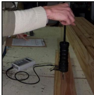
Figura 3.26. Medición de la humedad con un xilohigrómetro
