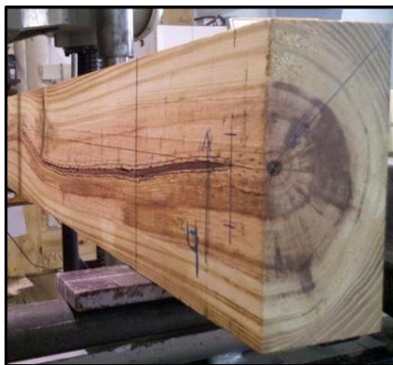
Figura 2.7. Médula en una pieza aserrada de pino resinoso
