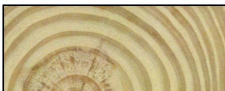
**Figura 2.6. Anillos de crecimiento en una sección de madera de pino resinoso**
