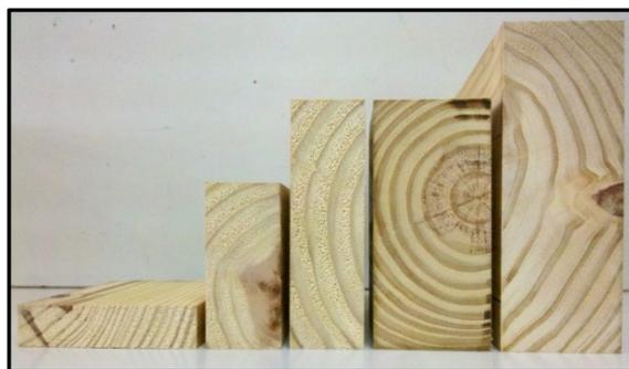
**Figura 3.3. De izq. a der.: Secciones transversales correspondiente a piezas aserradas 100x25 mm, 50x100 mm, 50x150 mm, 75x150 mm y 75x200 mm**
