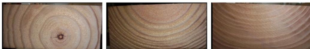
**Figura 3.6. Tipos de corte. De izq. a der.: Central con médula, central sin médula, tangencial**
