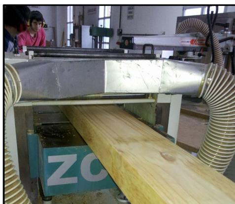
**Figura 3.2. Proceso de cepillado de las piezas aserradas**
