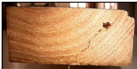
Figura 2.15. Rajadura en una pieza aserrada de pino resinoso
