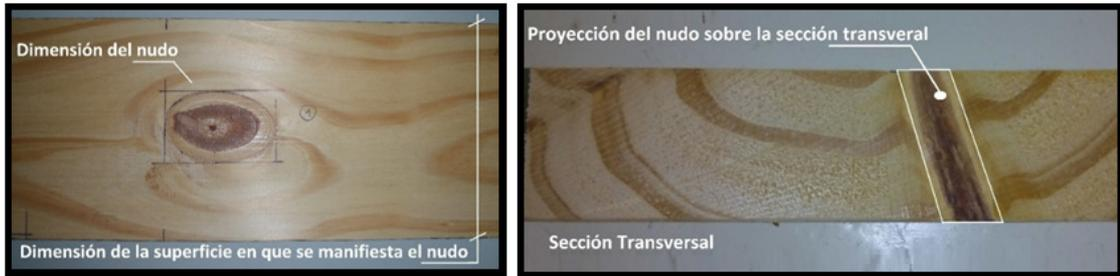
Figura 3.8. Medición de un nudo. Izq.: por apariencia. Der.: por desplazamiento
