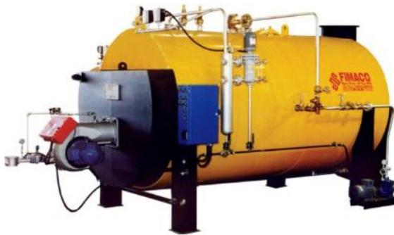
Caldera humotubular horizontal de tres pasos, de alta eficiencia térmica y rápida vaporización, circulación forzada de gases, ventilador centrífugo del quemador, desplazando los productos de la combustión del hogar, retornando la llama en sentido inverso
