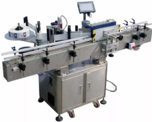
En este caso, el equipo trabaja a 220V 50-60Hz; con un motor de 1.0 Kw y dimensiones de 2000x1000x1300mm.
