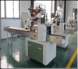
La estación de empacado, cuenta con 2 máquinas empacadoras ubicadas en paralelo que permiten conseguir la razón de empaque adecuado a la tasa de producción, y además, contar con una flexibilidad adicional, dado a que son máquinas delicadas y su función es crítica para la línea de procesamiento.
