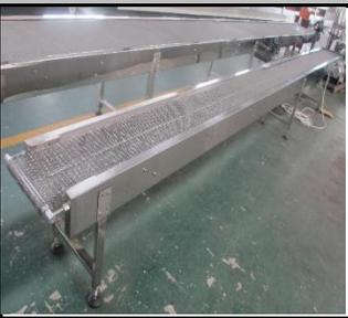
Luego de adquirir su cocción y brillo final, las galletas continúan su recorrido por una cinta de gran longitud, donde en virtud del recorrido y por acción del aire, pierden temperatura en función de poder ser empacadas para su posterior venta.
