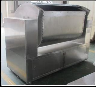
La operación comienza con el mezclado y amasado de las materias primas (agua, harina, aditivos, entre otros), siendo esta la estación de trabajo con mayor capacidad de producción relativa, sus principales pérdidas se deben a depósitos que quedan adheridos a las paredes de la máquina (que deben ser removidos previo al siguiente ingreso de materia prima).
