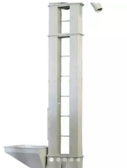
Ilustración 48 - Noria de Traslación
