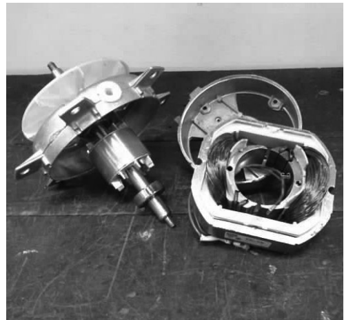
Fig. 2. Motor con circuito magnético tipo monofásico acorazado
