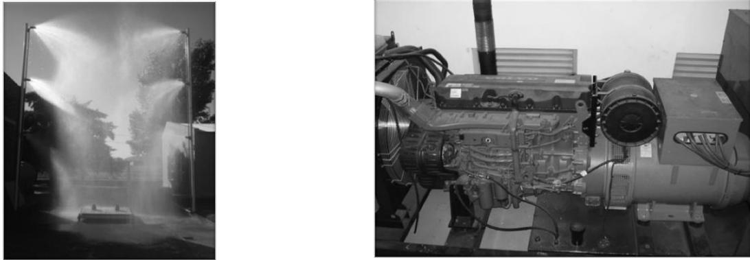
Fig. 4. Aparato simulador de lluvia y generador eléctrico de 400 kVA
