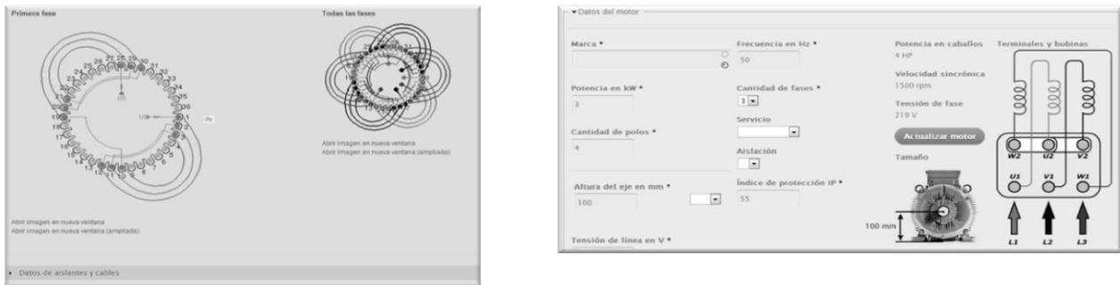
Fig. 14. Sitio ProGeBo: esquema de bobinado y datos del motor
