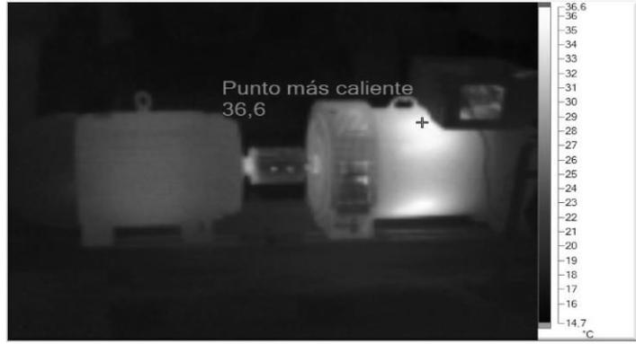
Fig. 10. Ensayo de un motor de imanes permanentes y una imagen térmica de un generador
