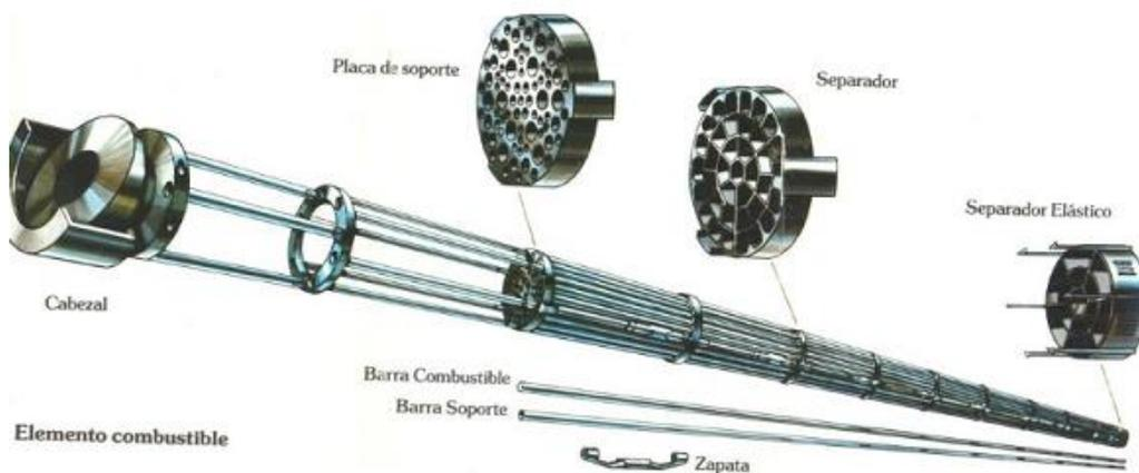
Figura 4. Partes del elemento combustible de Atucha I. (Rey y colaboradores, 2007)
