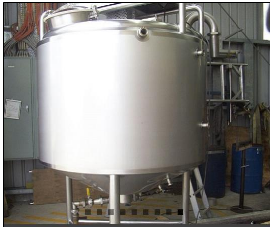
Figura 8.16 - Reactor Tanque Agitado con Camisa de calefacción.
