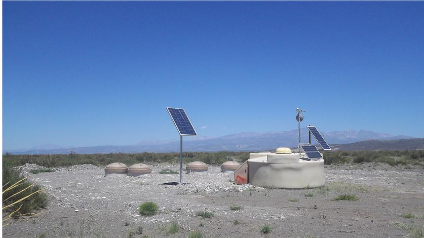
FIGURA 2.8: Fotografía de una posición del arreglo de ingeniería. Se puede observar un tanque detector del SD y los cuatro tubos de acceso de los módulos contadores de muones asociado a éste.
