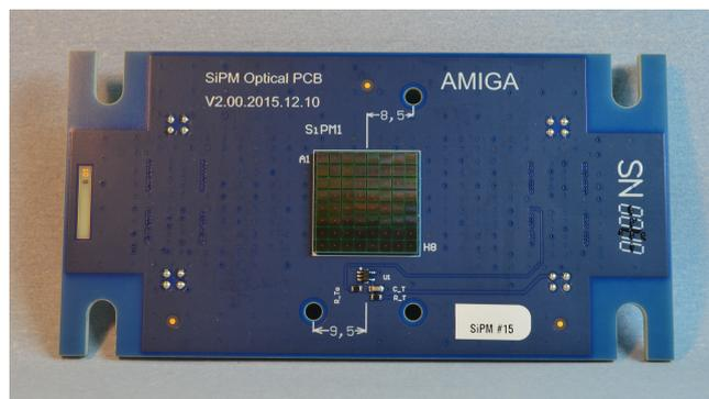
FIGURA 4.12: Fotografía de la placa que contiene el arreglo de 64 SiPMs utilizada en el sistema de detección del contador de muones de AMIGA.
