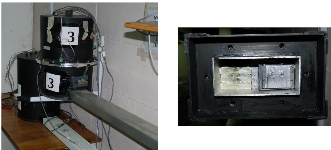
FIGURA 6.2: A la izquierda se muestra una fotografía del extremo de la *PIPA* en donde se encuentra el adaptador óptico y en donde se coloca la electrónica a medir. A la derecha se muestra una fotografía del extremo contrario de la *PIPA* con su tapa descubierta para poder observar el interior del perfil.
