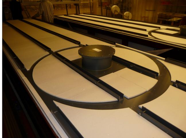
FIGURA 4.4: Fotografía de dos módulos contadores de muones de  $10\text{ m}^2$  fabricados en el laboratorio de mecánica del Instituto de Tecnología en Detección y Astropartículas (ITeDA). Se puede observar que ambos módulos poseen apliques de telgopor que le brindan de una protección adicional contra las rocas que se utilizarán para el blindaje.
