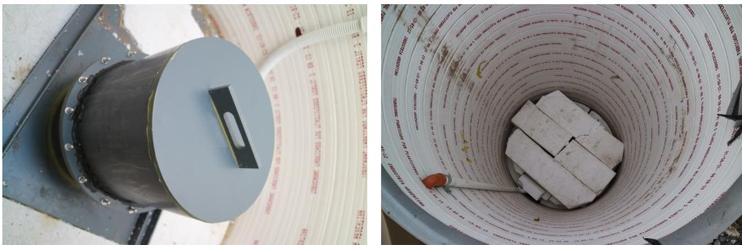
FIGURA 7.3: La fotografía de la izquierda muestra el cerramiento del recinto donde se encuentra la electrónica del módulo contador. La fotografía de la derecha muestra la colocación de los bloques de poliestireno expandido.
