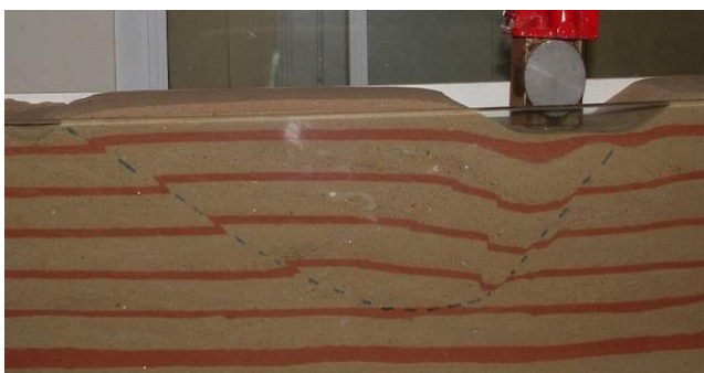
Figura N° 4: Falla de una base apoyada sobre un manto de arena.
