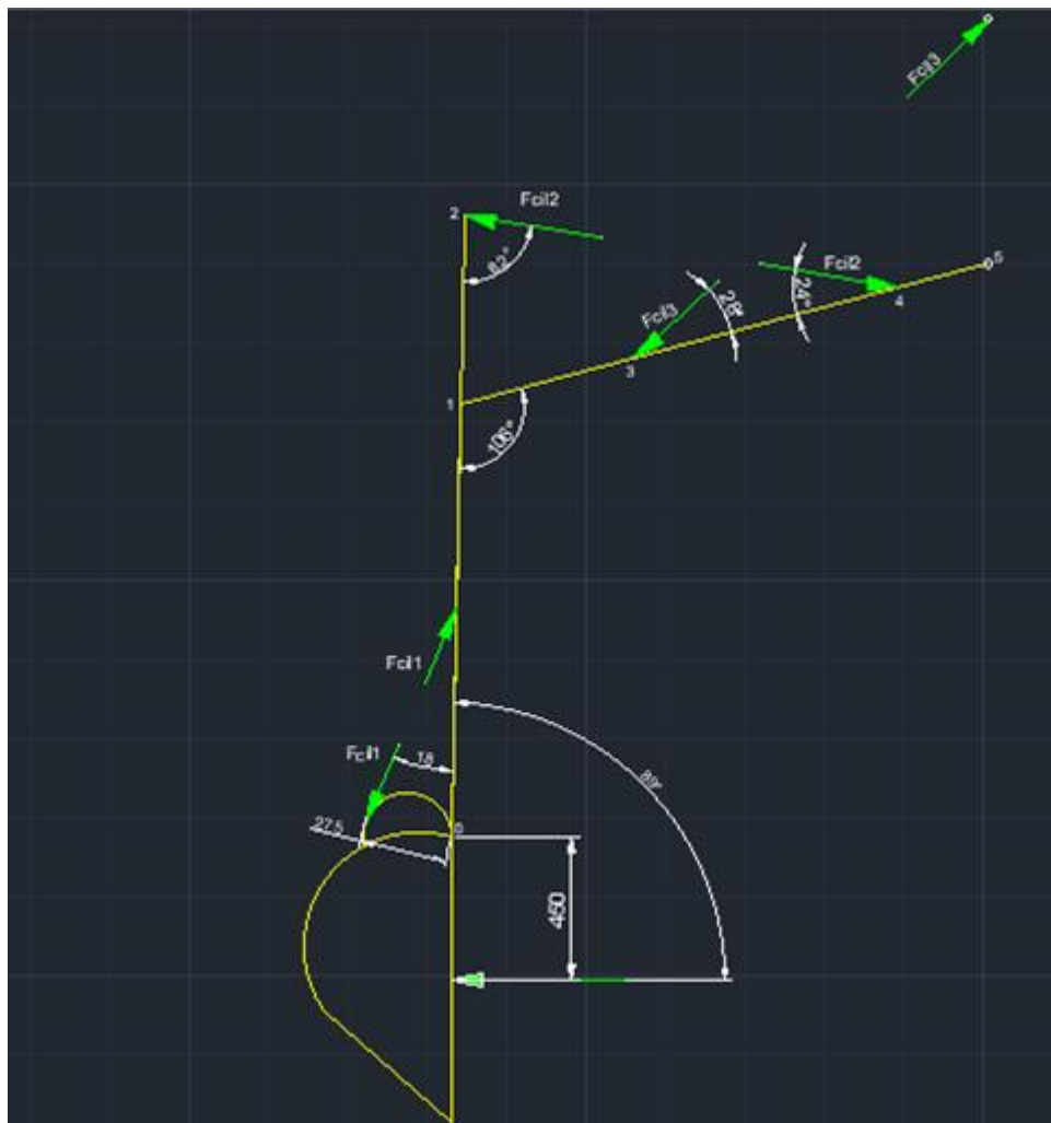
Fig. N° 31: Fuerzas actuantes, posición que se usa para calcular el brazo.
