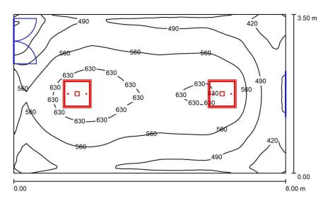
Altura del local: 3.000 m, Altura de montaje: 3.595 m, Factor mantenimiento: 0.80
