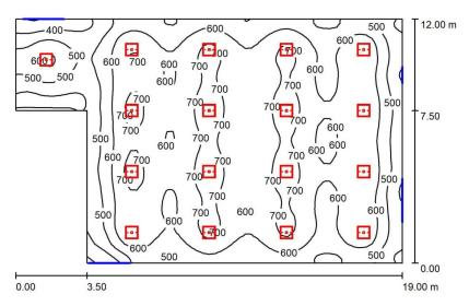
Altura del local: 3.500 m, Altura de montaje: 3.500 m, Factor mantenimiento: 0.80
