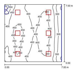
Altura del local: 3.100 m, Altura de montaje: 3.595 m, Factor mantenimiento: 0.80
