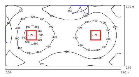
Altura del local: 3.100 m, Altura de montaje: 3.595 m, Factor mantenimiento: 0.80
