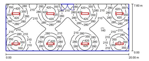
Altura del local: 3.000 m, Altura de montaje: 3.595 m, Factor mantenimiento: 0.80
