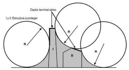
Los conductores del sistema aéreo deberán estar instalados sobre todos los puntos y segmentos que están en contacto con la esfera rodante.
