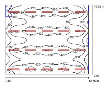
Altura del local: 2.800 m, Altura de montaje: 2.800 m, Factor mantenimiento: 0.80
