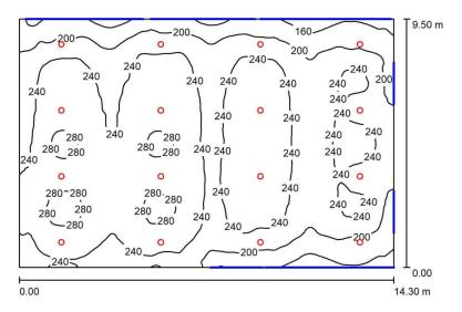
Altura del local: 3.500 m, Altura de montaje: 3.595 m, Factor mantenimiento: 0.80
