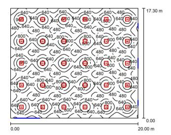
Altura del local: 3.500 m, Altura de montaje: 2.800 m, Factor mantenimiento: 0.80
