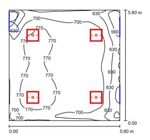
Altura del local: 3.000 m, Altura de montaje: 3.595 m, Factor mantenimiento: 0.80
