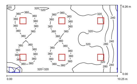
Altura del local: 3.100 m, Altura de montaje: 3.595 m, Factor mantenimiento: 0.80
