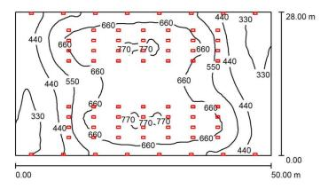
Altura del local: 8.000 m, Altura de montaje: 7.824 m, Factor mantenimiento: 0.80
