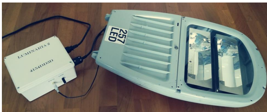
Figura 89 –Vista Completa del controlador de luminaria y la luminaria ya conectada
