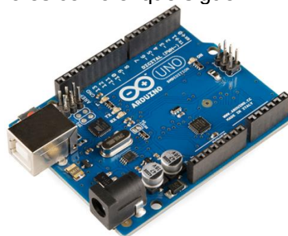
Figura 9 – Arduino Uno R3
