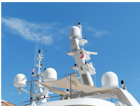
Figura 1.2: Ejemplos de antenas parabólicas móviles. En el caso de la imagen de la izquierda, las antenas se encuentran dentro de los domos (radomos) para protegerlas de las inclemencias climáticas. Recuperado de: https://es.123rf.com/
