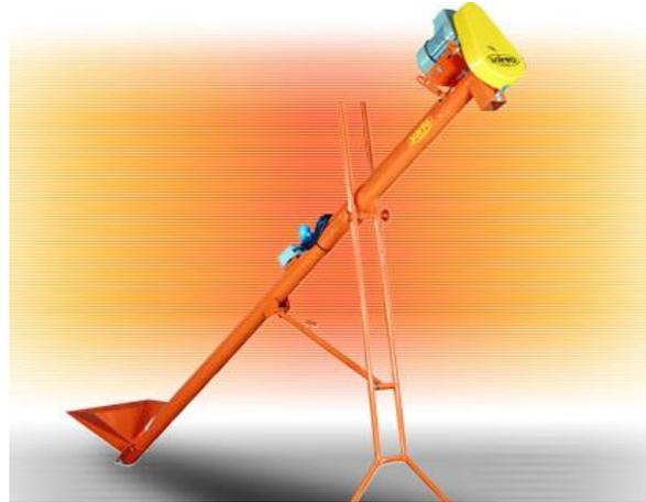
Figura 4-41: Transportador helicoidal.
