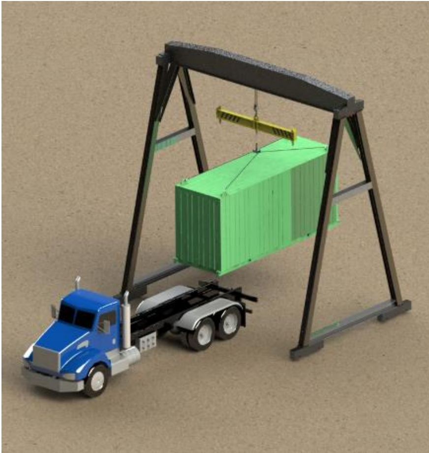
Ilustración 14 Descarga por pórtico auto portante
