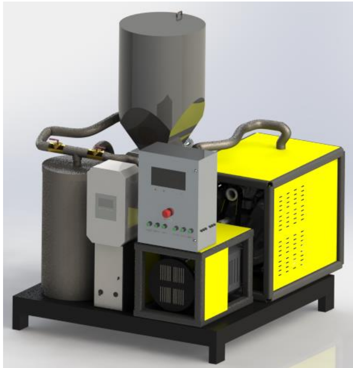
Ilustración 16 Simulación del Biogenerador
