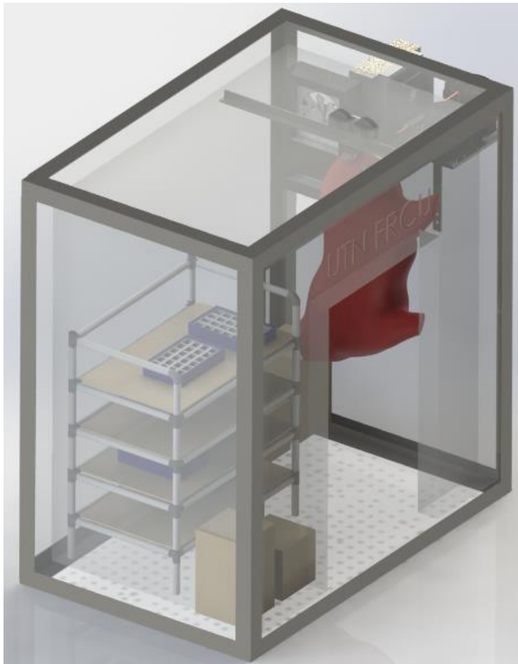
Ilustración 16 R01 - Cámara frigorífica
