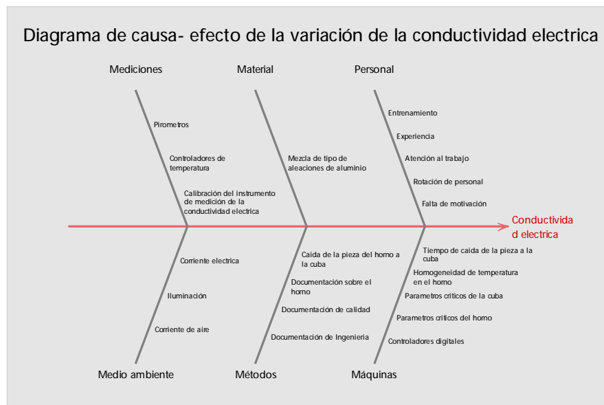
Fig. N° 5.2. Diagrama de causa-efecto de la variación de la conductividad eléctrica.
