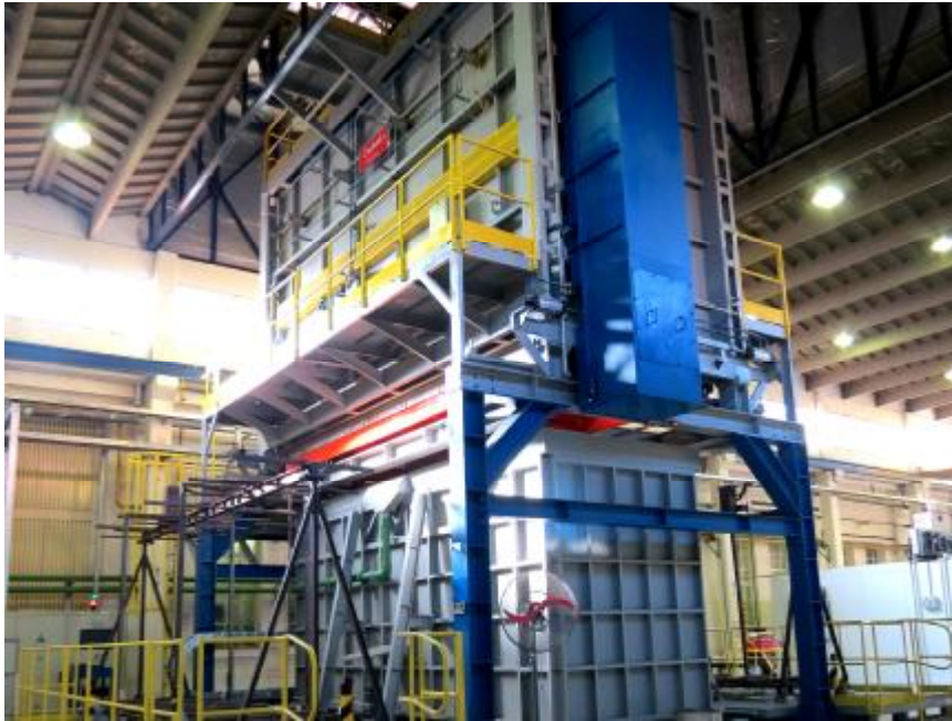
Fig. N° 4.6. Alineación del horno con la cuba de enfriamiento con la identificación de los factores (Secretaría de Ciencia, Tecnología y Producción para la Defensa, 2013).
