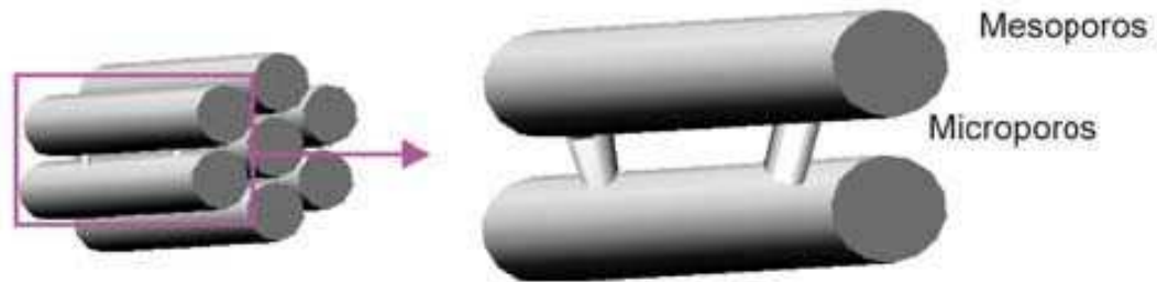
Figura 1.2. Esquema del sistema poroso en la SBA-15
