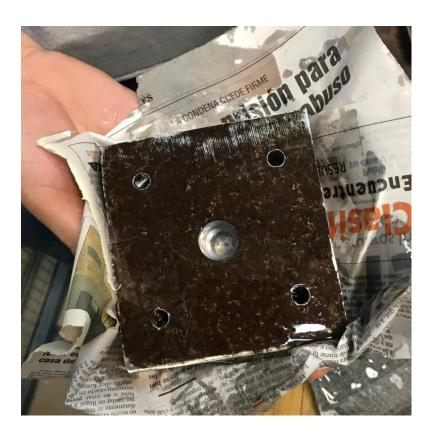
La pieza de sujeción se fijó al CNC con un tornillo de cabeza Allen alojado en el centro de la pieza. Lo primero que se hizo fue un plano para nivelar la cara superior de la pieza, luego se hizo un agujero pasante de 15 mm de diámetro y una profundidad de 20 mm por donde pasó el tornillo Allen, y para alojar la cabeza del tornillo se hizo un agujero de 20 mm de diámetro y 10 mm de profundidad, como se ve en la figura.
