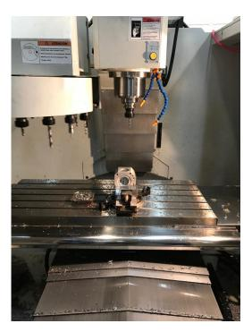
Para la realización de los agujeros, se montó el block en la morsa del CNC y luego con una herramienta centradora se niveló el plano superior y se centró el agujero del cilindro guía. Una vez centrado y nivelado se procedió con la operación de agujereado. Para ello se hicieron 3 pasos:
