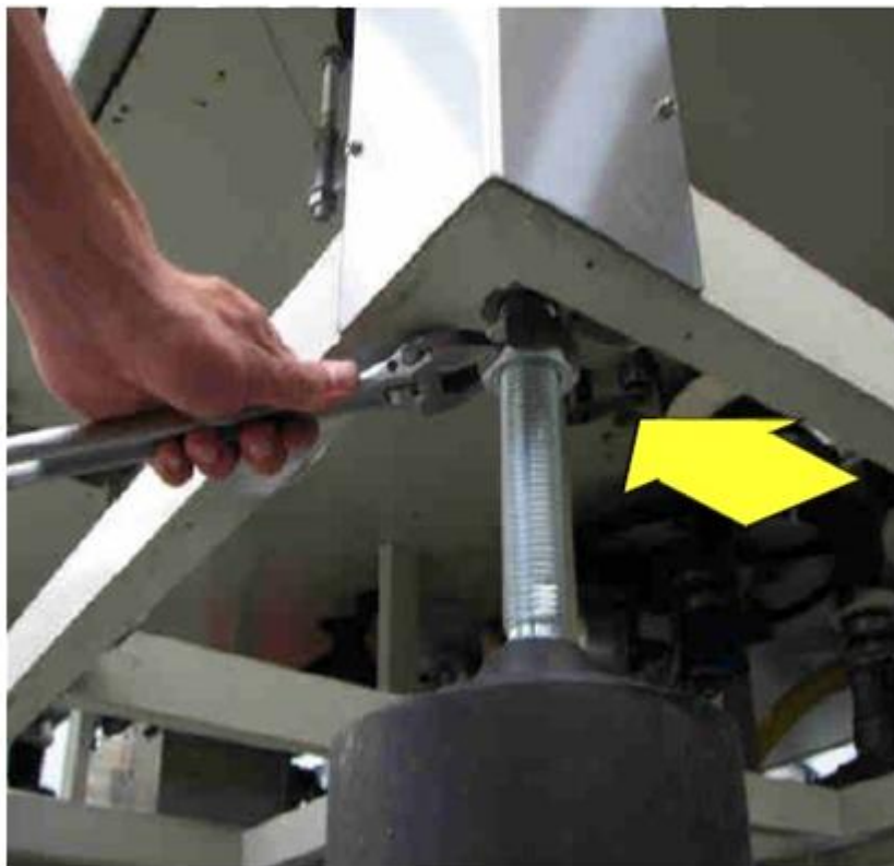
Figura 4 Ajuste de los apoyos de la máquina etiquetadora
