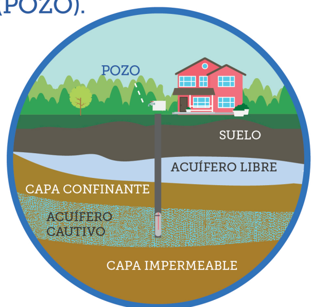
Figura 6: Captación individual (pozo).
