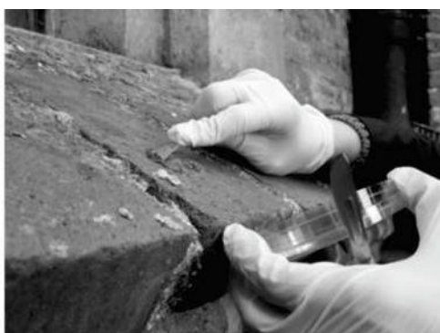
Figura 8. Muestra del manto biológico para su identificación en Laboratorio.
