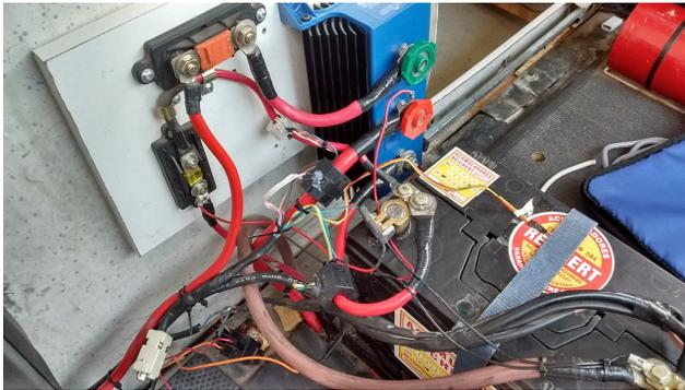
Imagen 39 - Sensores Batería Aux1 [36]
