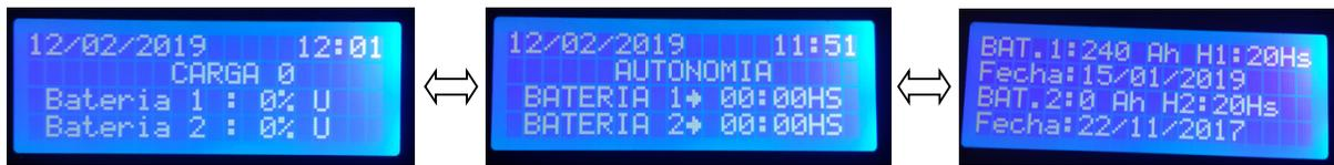
Con los botones de desplazamiento se pueden alternar entre las tres pantallas, la segunda pantalla muestra la autonomía y la tercera pantalla muestra los datos y las fechas de instalación de cada batería.
