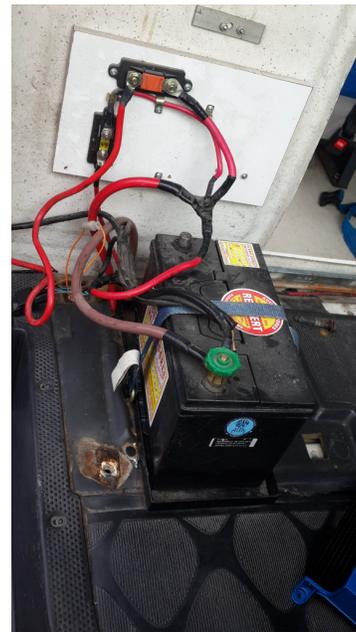
Se retiró el asiento del acompañante para la posterior instalación del aislador de cargas
