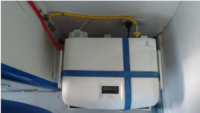
El Compresor Mini proporciona un flujo continuo de aire presurizado en ausencia de un suministro central de gas o cilindros de gas. Usando aire circundante, el compresor recolecta y almacena gas, para uso directo con el sistema de ventilación SERVO-I, siempre y cuando el ventilador esté activo.
