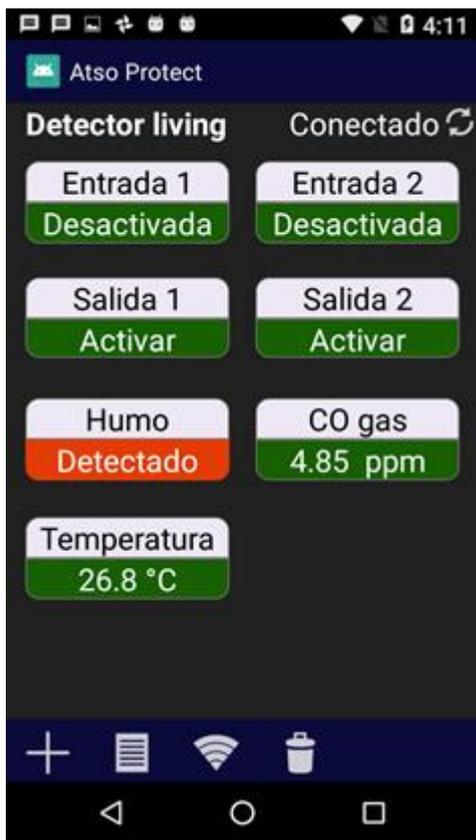
Figura 46: Vista del estado del detector con de sensor de humo activado
