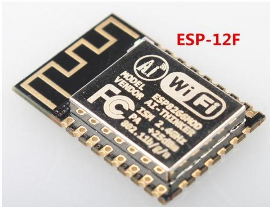
*Figura 12: Modulo ESP-12F*
