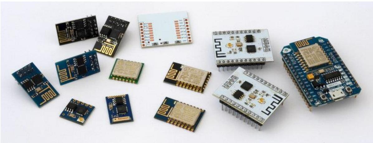
Figura 11: Modelos de Módulos ESP8266
