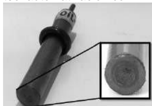
Figura 1. Electrodo de pasta de carbono (CPE) elaborado en el presente estudio
