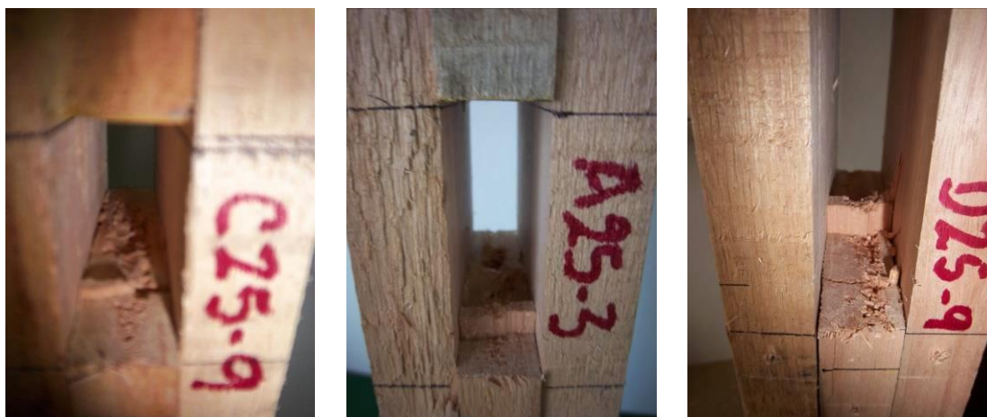
Figura 4.13 Cuerpos de prueba presentando roturas por bloque de corte.
