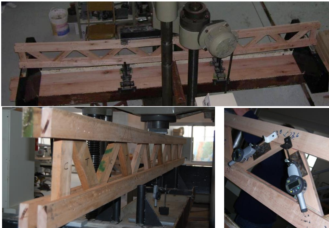
Figura 3.16 Detalles constructivos de las vigas y ubicación de los dispositivos de ensayo. Dispositivos de apoyo y de aplicación de las cargas en los tercios de la luz (arriba), ubicación del comparador para medir las deformaciones en el centro de la viga (abajo, izquierda), extensómetros para registrar el deslizamiento en una conexión comprimida y en una traccionada (abajo, derecha).
