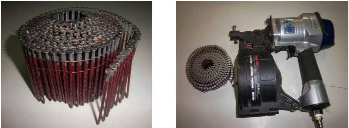
Figura 3.5 Clavos y clavadora neumática usados para la preparación de los cuerpos de prueba.
