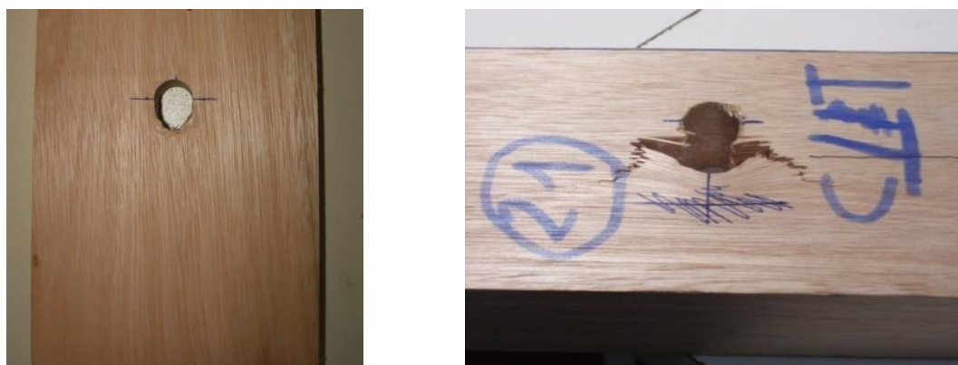
Figura 4.4 Cuerpos de prueba ensayados con un bulón rígido luego de alcanzada la carga de rotura por aplastamiento en compresión paralela (izquierda) y en compresión perpendicular (derecha) a la dirección de las fibras.
