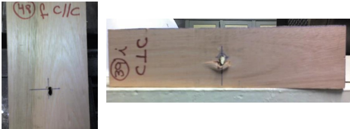
Figura 4.1 Cuerpos de prueba con un clavo rígido luego de alcanzar la carga de rotura por aplastamiento, ensayados en compresión paralela (izquierda) y en compresión perpendicular (derecha) a la dirección de las fibras.
