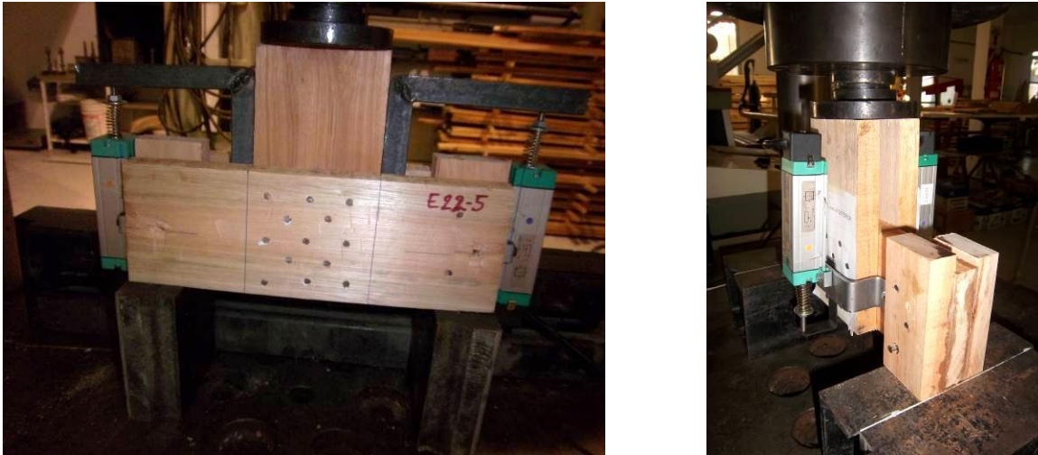
Figura 3.12 Cuerpos de prueba durante el proceso de aplicación de la carga de compresión sobre el miembro vertical. Configuración con dos tablas horizontales (izquierda) y con una tabla horizontal (derecha).
