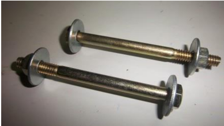
Figura 3.9 Bulones, tuercas y arandelas usados para la preparación de los cuerpos de prueba.
