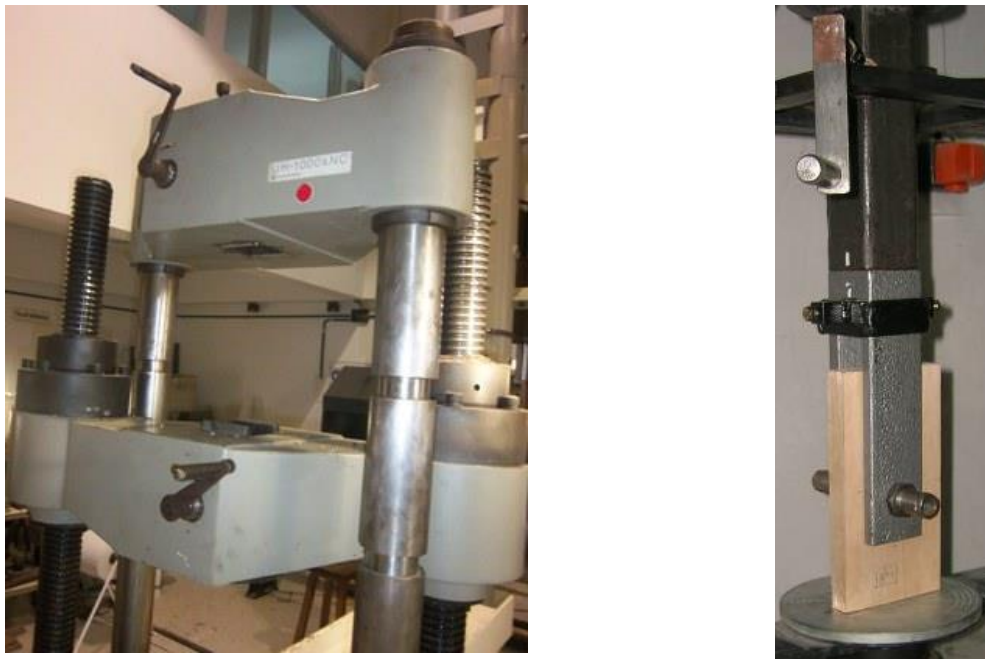
Figura 3.3 Equipamiento empleado para los ensayos de aplastamiento según la norma EN 383 (2007). Máquina de ensayos universales (izquierda) y dispositivo auxiliar de carga (derecha).
