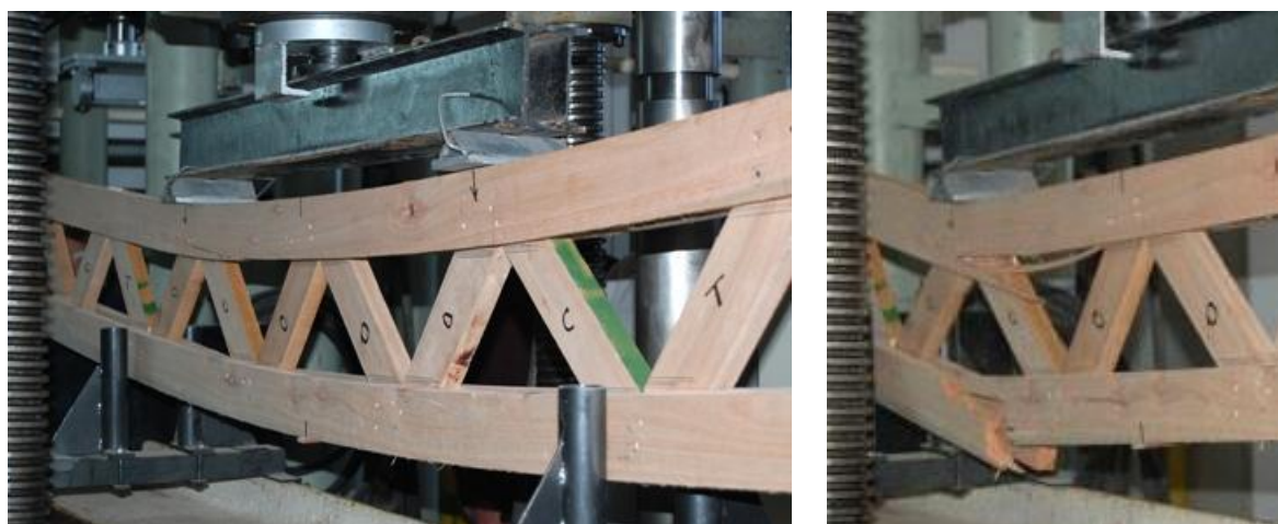
Figura 4.19 Estructura reticulada (viga 1) durante la realización del ensayo (izquierda) y una vez culminado el mismo (derecha).
