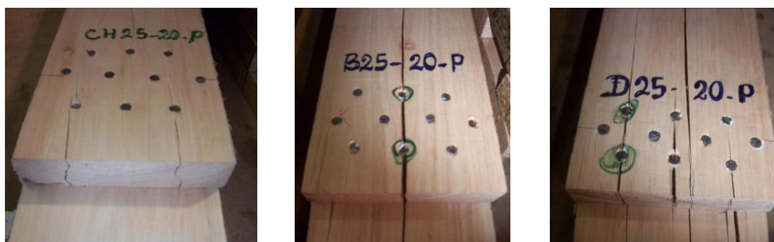
Figura 4.12 Fisuración en los mismos cuerpos de prueba presentados en Figura 4.11, luego de culminar el ensayo.
