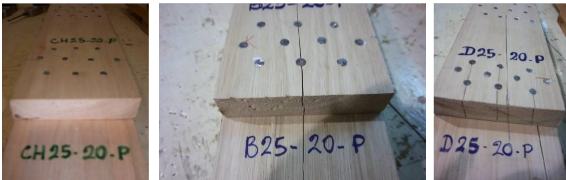
Figura 4.11 Fisuración en cuerpos de prueba antes de ser ensayados, pertenecientes a sub-muestras con la mayor, intermedia y menor separación entre elementos y a los bordes.
