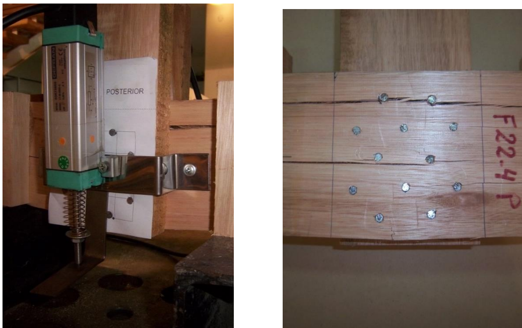
Figura 4.15 Fisuración paralela a las fibras, originada por las tensiones cortantes en el miembro transversal, conformado con una tabla (izquierda) y con dos tablas (derecha).
