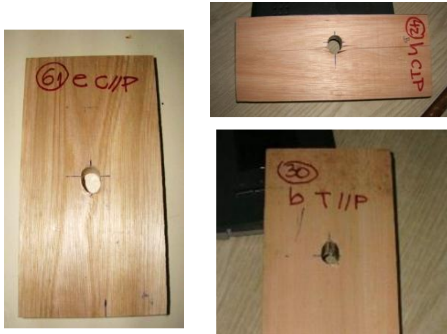
Figura 4.7 Cuerpos de prueba con un pasador rígido luego de alcanzada la carga de rotura bajo compresión paralela a la dirección de las fibras (izquierda), compresión perpendicular (derecha superior) y tracción paralela (derecha inferior).
