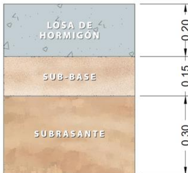
Figura 5-13: Composición de paquete estructural. Fuente: Autoría propia.
