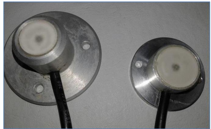
Fig. 5. Celdas fotovoltaicas calibradas utilizadas.
